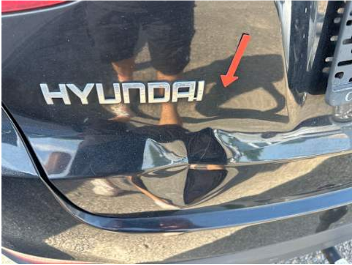
Heckklappe (Delle, Kratzer)
