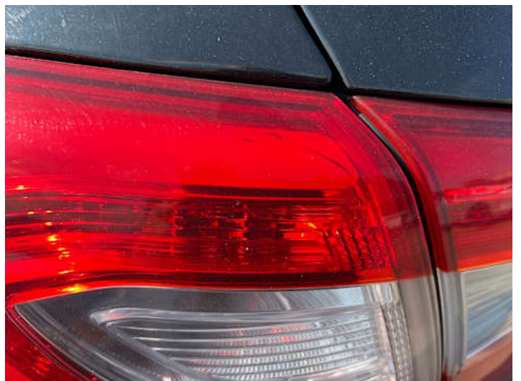
Rücklicht (links) (Riss/Bruch)
