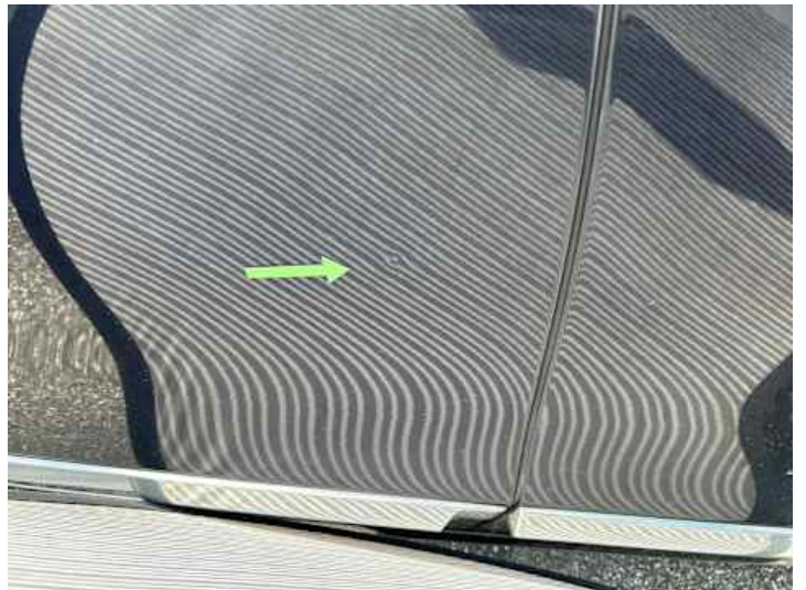
Türe hinten rechts (Delle, Lackschaden)
