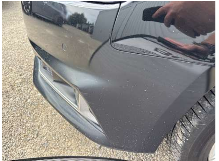
Stoßstange vorne (Kratzer, Lackschaden, Unsachgemäß instand gesetzt)
