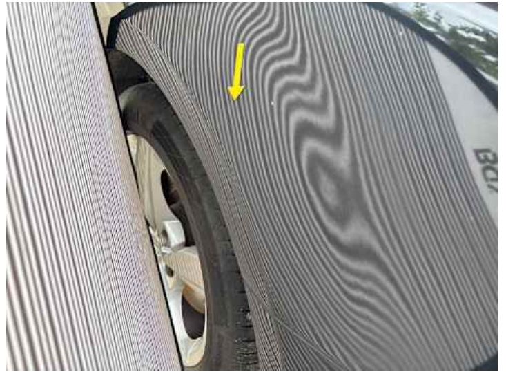
Seitenteil hinten links (Lackschaden, Unsachgemäß instand gesetzt)
