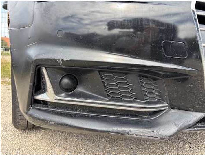
Stoßstange vorne (Kratzer, Lackschaden, Unsachgemäß instand gesetzt)
