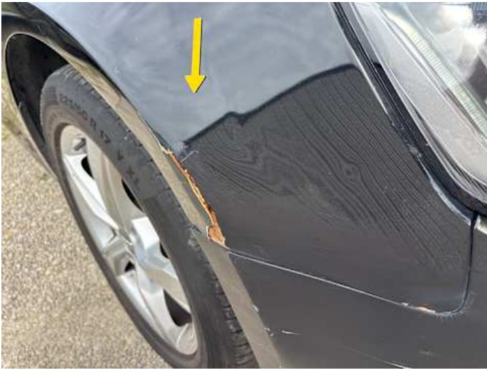
Kotflügel vorne rechts (Rost, Riss/Bruch, Lackschaden)
