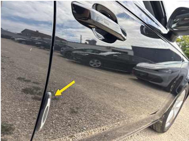
Beifahrtür (Unsachgemäß instand gesetzt)
