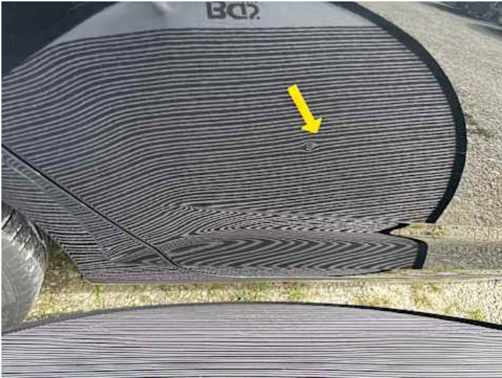
Türe hinten rechts (Delle)
