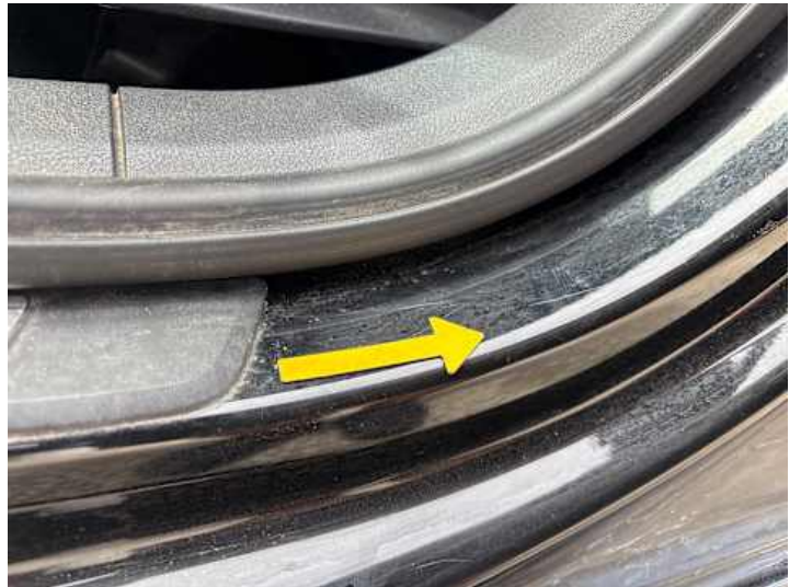
Schweller links (Kratzer)
