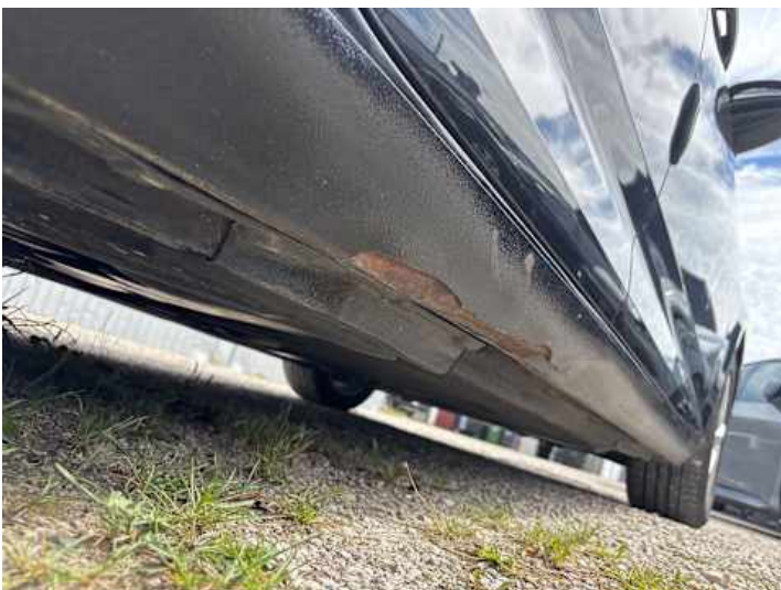
Schweller rechts (Rost, Riss/Bruch, Verformung, Lackschaden)
