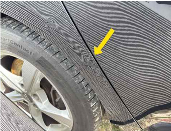
Seitenteil hinten rechts (Verformung)
