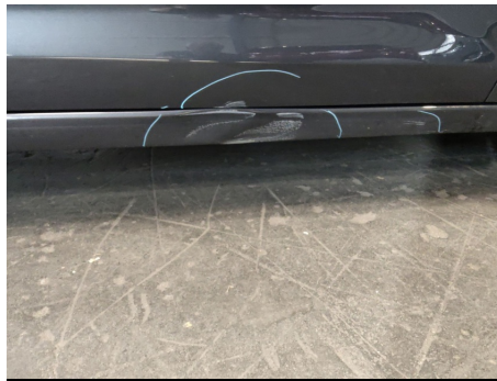
Schweller / Vorne Rechts / Delle
