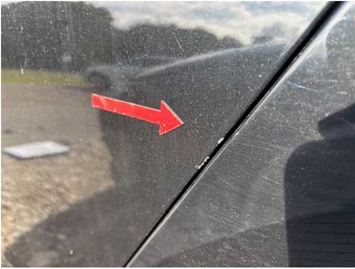
Türe hinten links (Kratzer)
