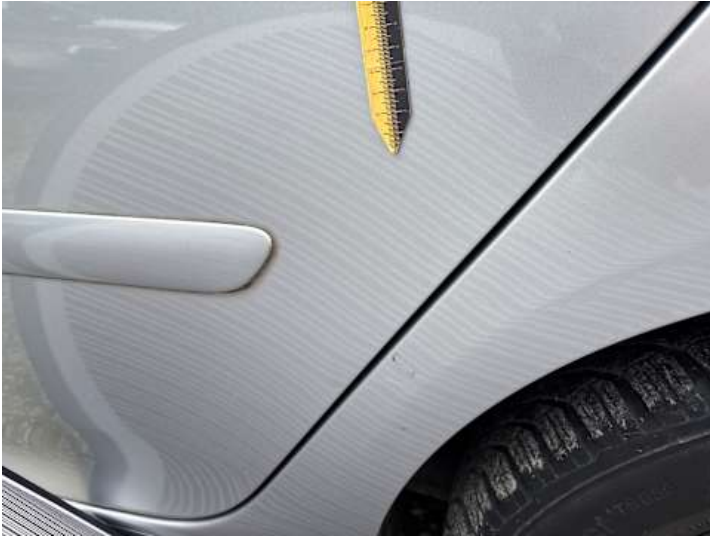
Türe hinten links (Delle, Lackschaden)
