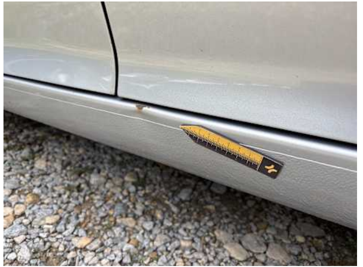
Schweller links (Rost, Verformung)
