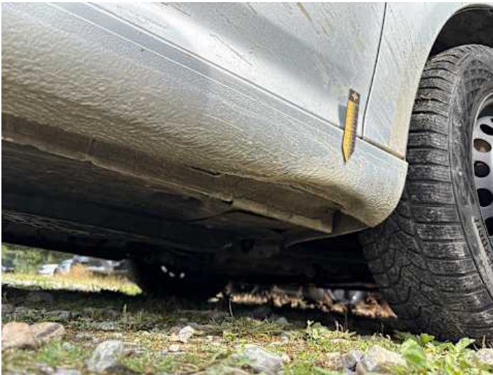
Schweller rechts (Verformung, Lackschaden, Rost)
