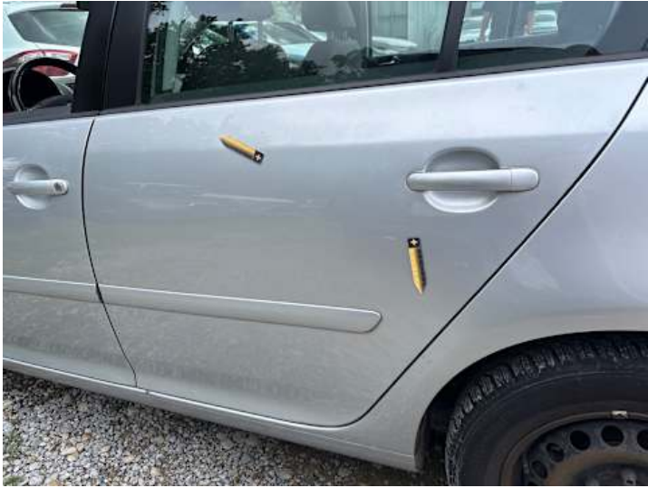
Türe hinten links (Delle, Lackschaden)
