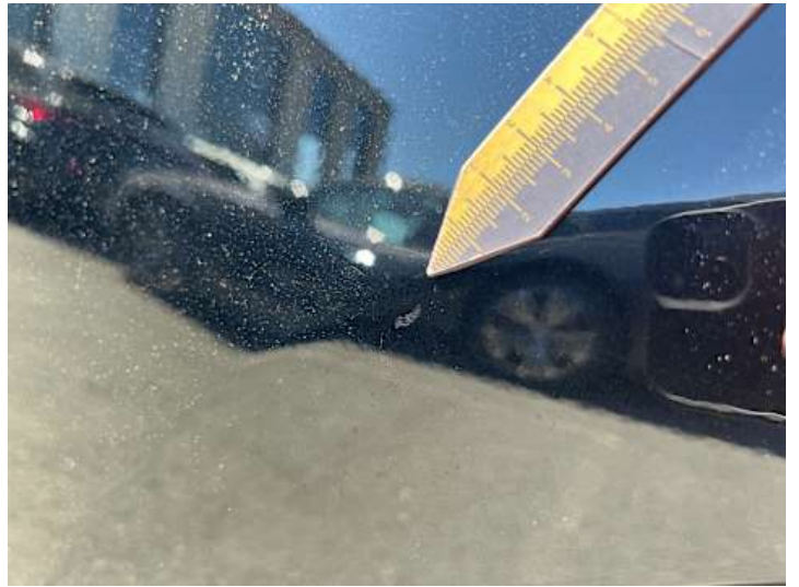
Türe hinten links (Kratzer, Unsachgemäß instand gesetzt)
