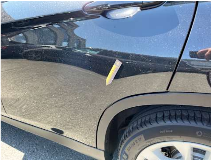
Türe hinten links (Kratzer, Unsachgemäß instand gesetzt)
