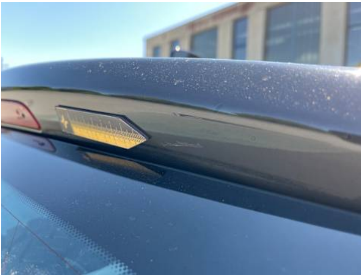
Heckklappe (Kratzer, Unsachgemäß instand gesetzt)
