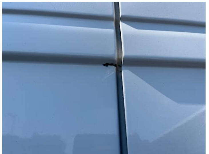
Heckklappe (Delle, Kratzer, Spaltmaße ungenau)
