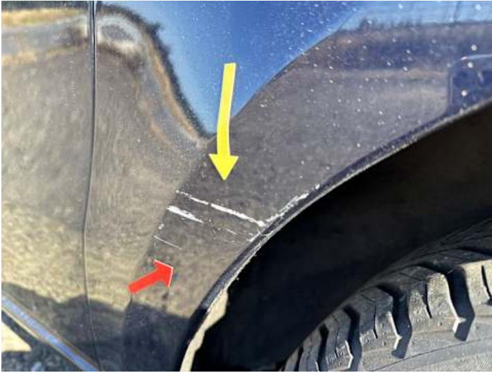
Seitenteil hinten links (Lackschaden, Kratzer)
