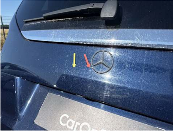
Heckklappe (Kratzer, Lackschaden)
