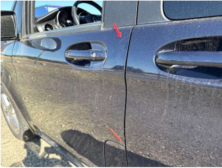
Fahrtür (Lackschaden, Kratzer)
