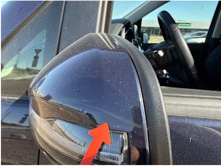
Fahrtür (Kratzer, Unsachgemäß instand gesetzt)
