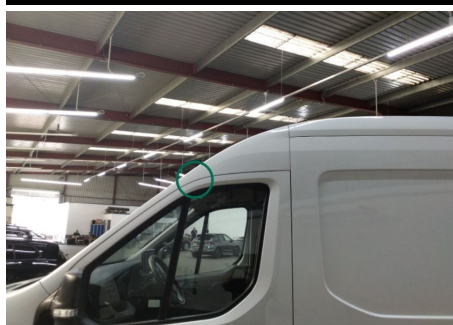
Dachholm / Vorne Links / Kratzer
