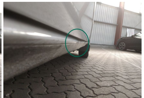
Schweller / Rechts / Delle
