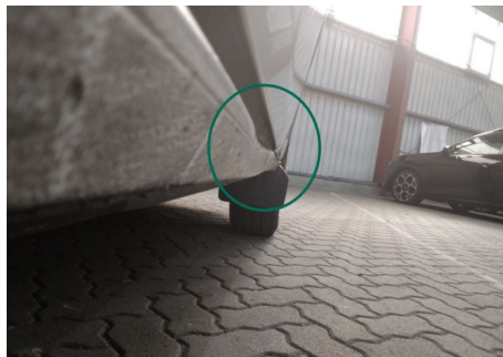
Schweller / Rechts / Delle
