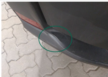
Stoßfänger / Hinten / Gebrochen
