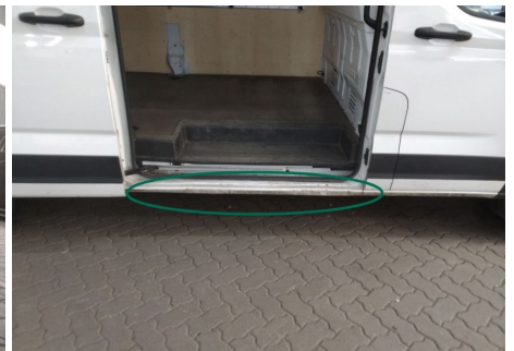
Schweller / Rechts / Delle
