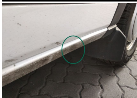
Schweller / Vorne Rechts / Delle
