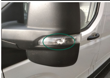
Blinker / Links / Gebrochen
