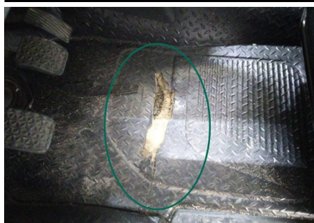
Fußmatten / Vorne Links / Gebrochen
