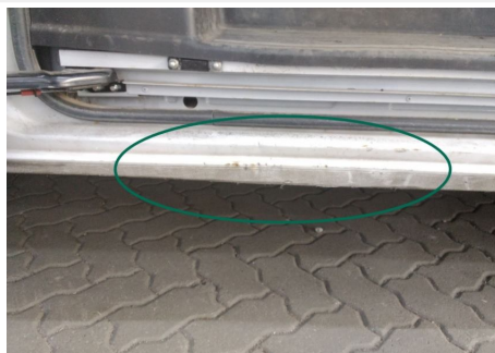
Schweller / Rechts / Delle
