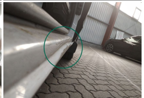
Schweller / Rechts / Delle
