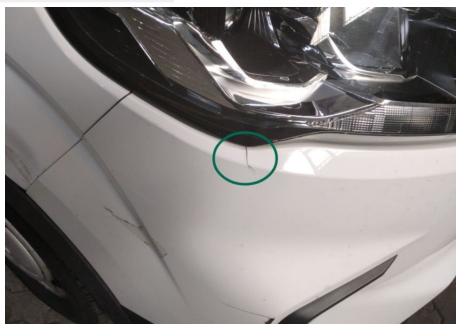
Stoßfänger oberhalb / Vorne / Gebrochen
