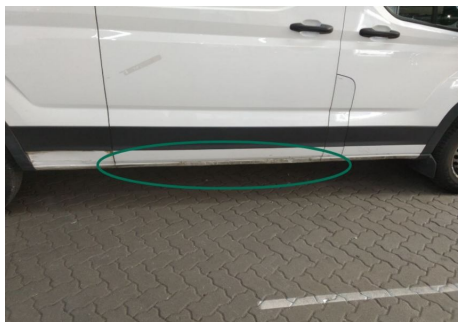
Schweller / Rechts / Delle
