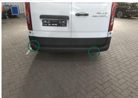
Stoßfänger / Hinten / Gebrochen
