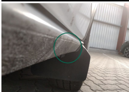
Schweller / Vorne Rechts / Delle
