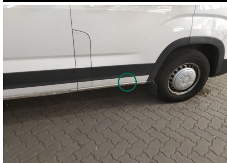
Schweller / Vorne Rechts / Delle
