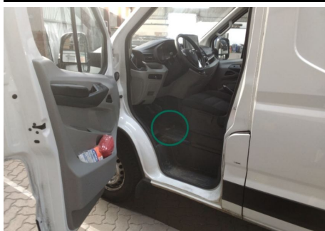
Fußmatten / Vorne Links / Gebrochen
