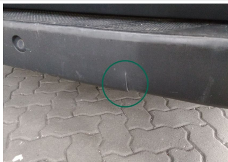
Stoßfänger / Hinten / Gebrochen
