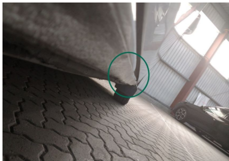
Schweller / Rechts / Delle
