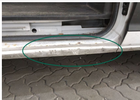
Schweller / Rechts / Delle
