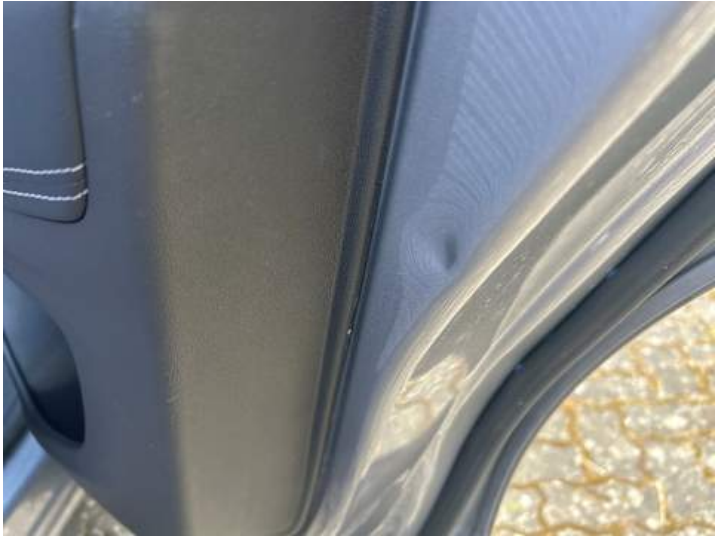
Türe hinten rechts (Delle)
