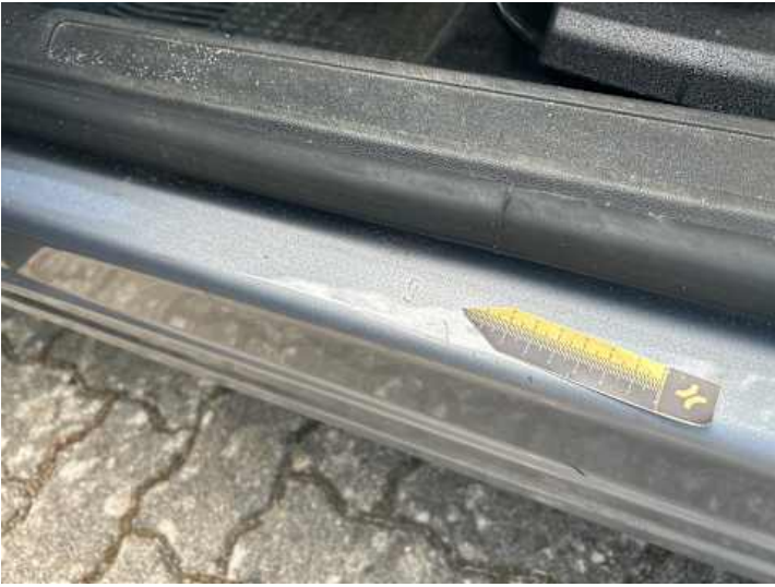
Schweller links (Delle, Kratzer)
