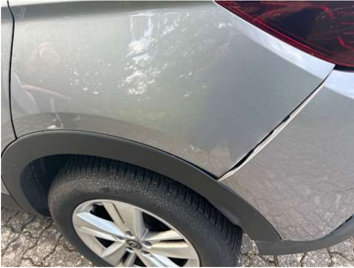
Seitenteil hinten links (Spaltmaße ungenau)
