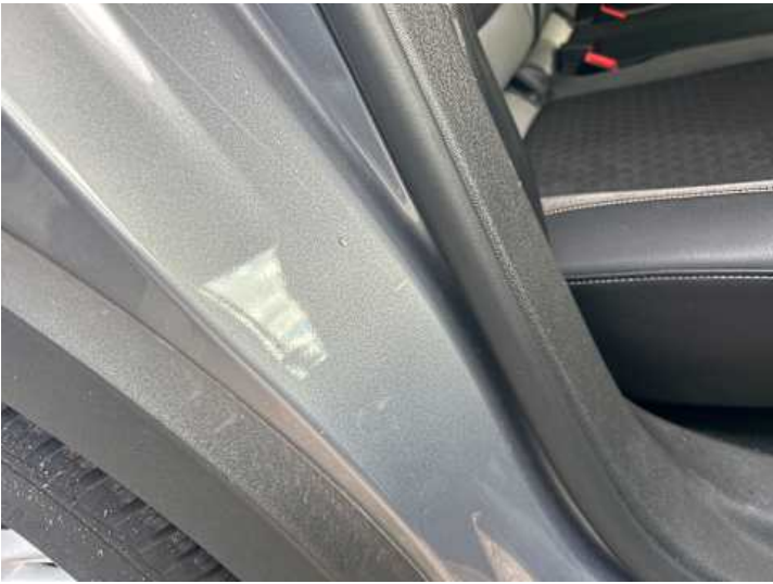
Schweller rechts (Kratzer)
