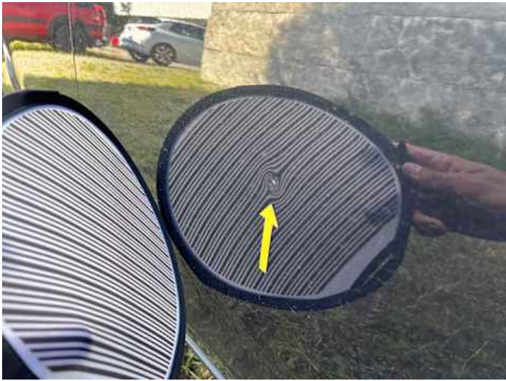
Beifahrertür (Kratzer, Delle)
