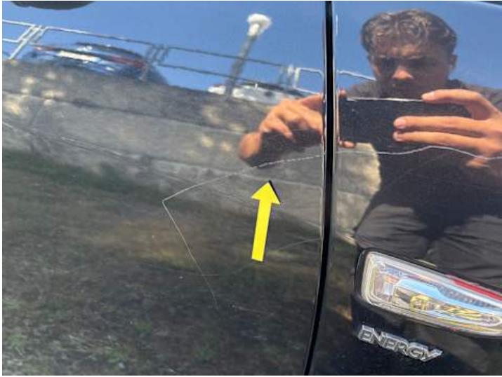
Beifahrertür (Kratzer, Delle)
