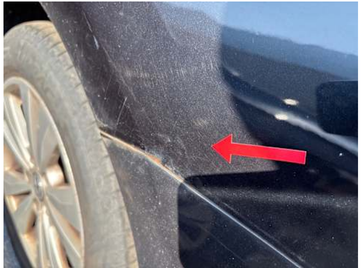
Seitenteil hinten links (Rost)
