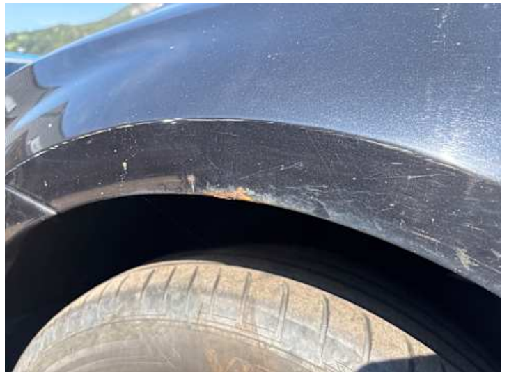
Kotflügel vorne links (Rost, Kratzer)
