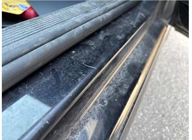
Schweller rechts (Kratzer)
