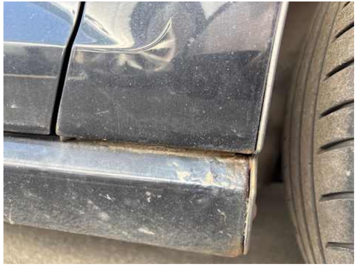
Kotflügel vorne rechts (Rost)
