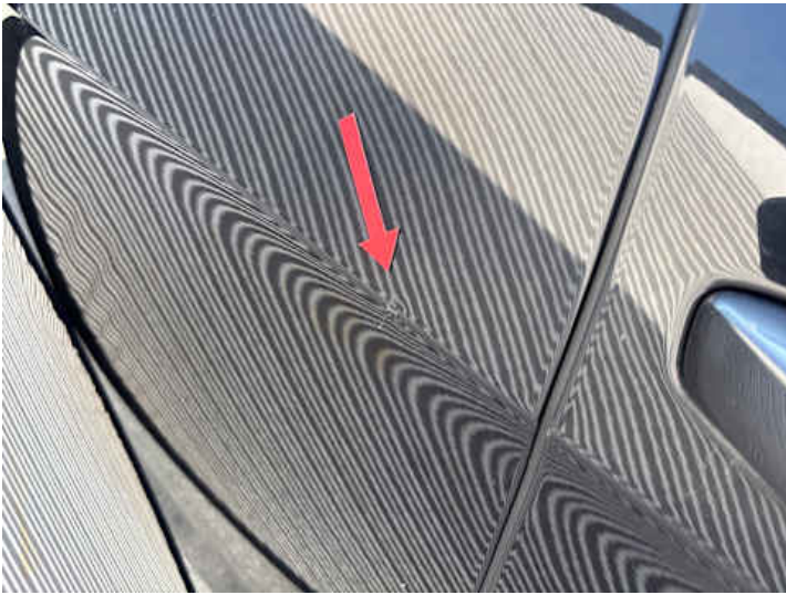
Türe hinten rechts (Delle, Lackschaden)
