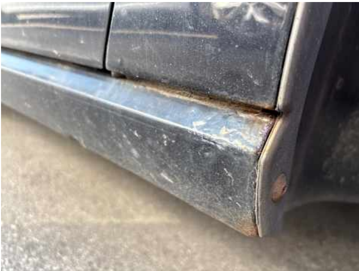
Schweller rechts (Rost)
