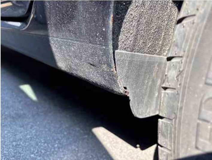
Schweller links (Rost)
