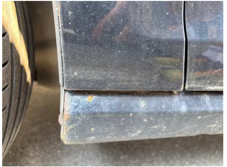
Schweller links (Rost)
