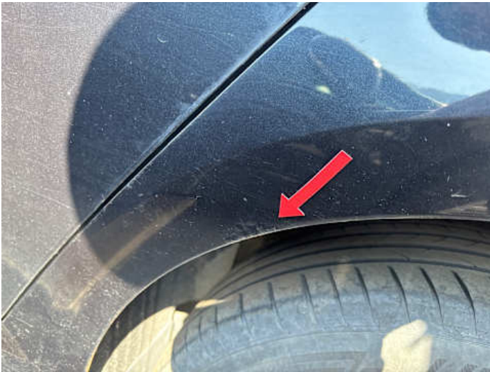
Seitenteil hinten links (Rost)
