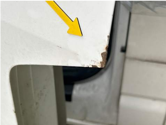
Fahrtür (Rost, Kratzer)
