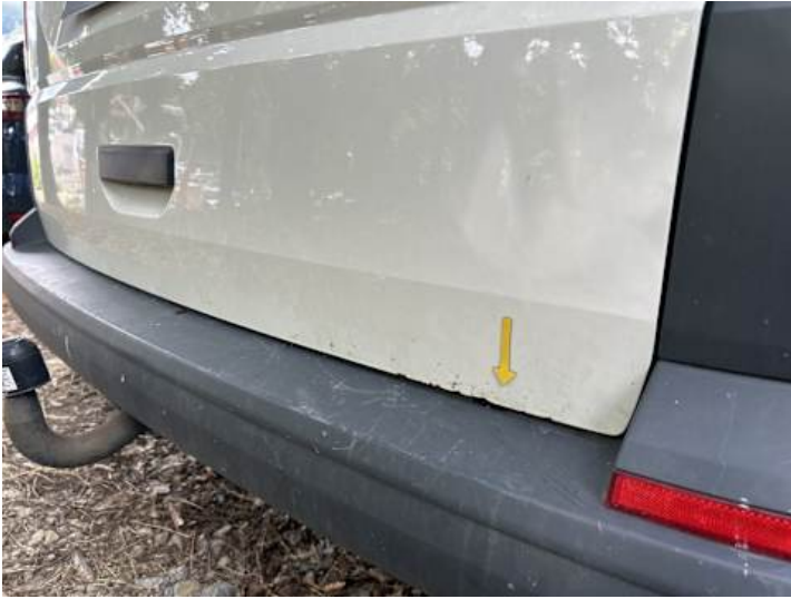
Heckklappe (Kratzer, Rost)
