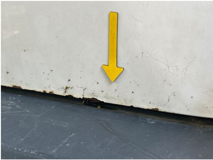
Heckklappe (Kratzer, Rost)
