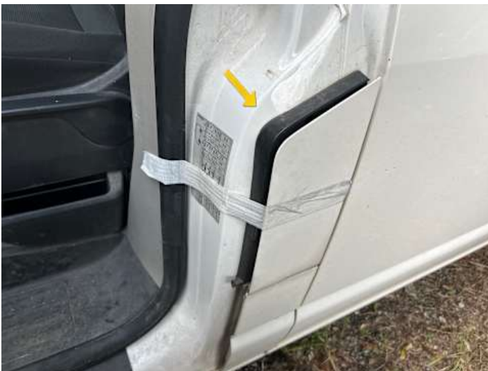
Fahrtür (Unsachgemäß instand gesetzt)
