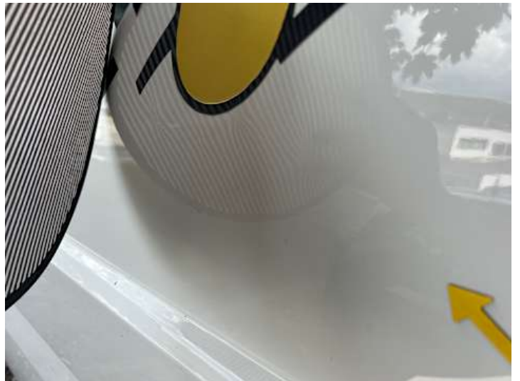
Seitenteil hinten links (Verformung)
