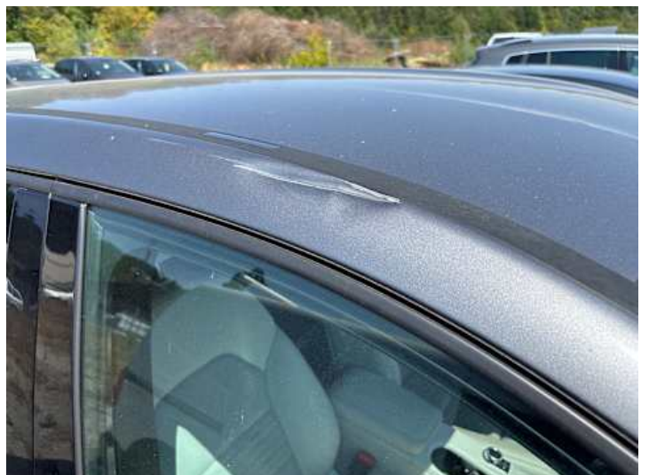
Dach (Verformung, Kratzer, Delle)
