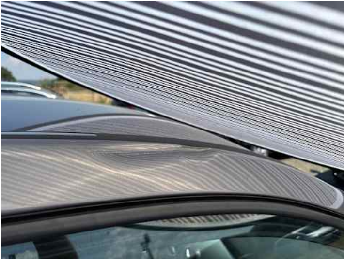
Dach (Verformung, Kratzer, Delle)
