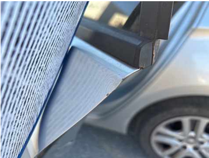
Türe hinten links (Kratzer, Verformung)
