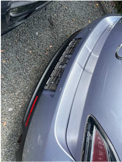
Stoßstange hinten (Kratzer)
