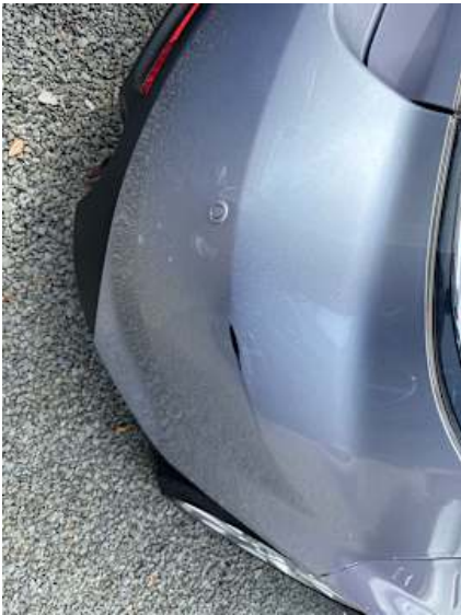
Stoßstange hinten (Kratzer)
