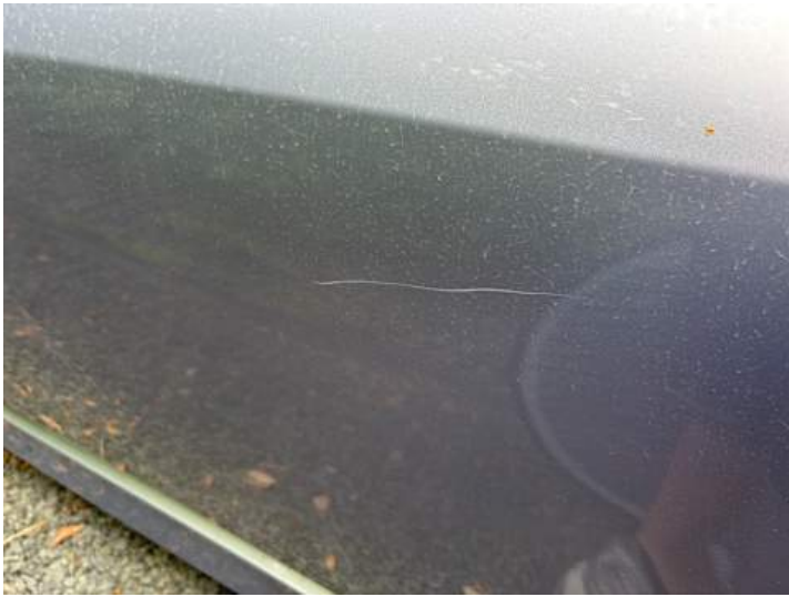
Türe hinten links (Kratzer)
