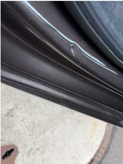
Schweller rechts (Kratzer, Delle)
