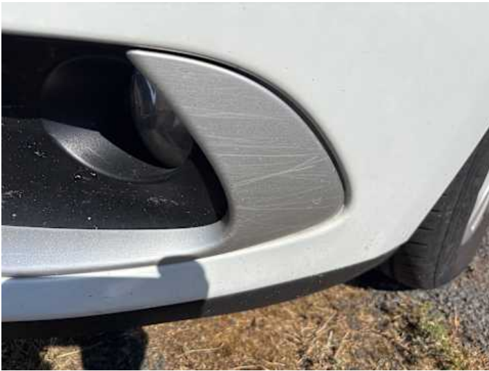
Stoßstange vorne (Kratzer, Anderer Schaden): Wassereintritt,
