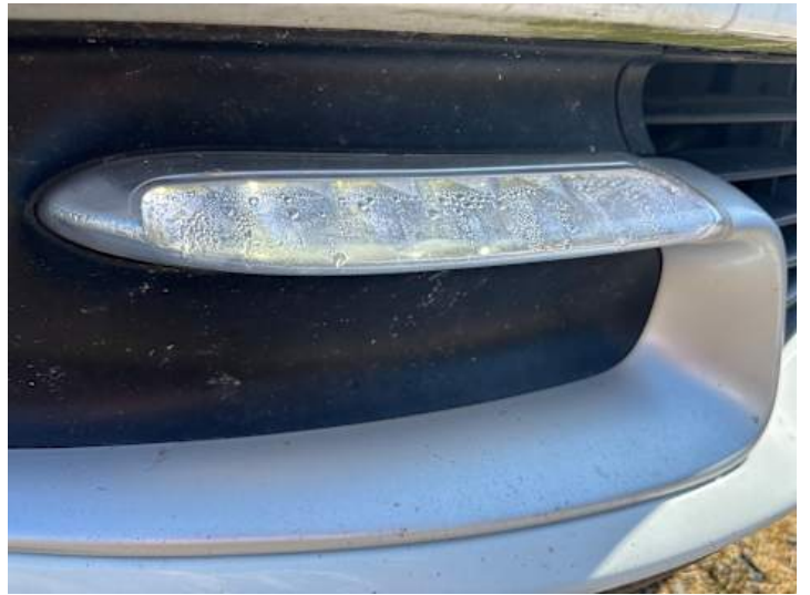
Stoßstange vorne (Kratzer, Anderer Schaden): Wassereintritt,
