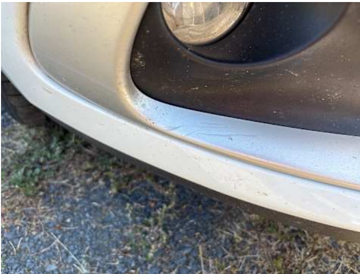
Stoßstange vorne (Kratzer, Anderer Schaden): Wassereintritt,
