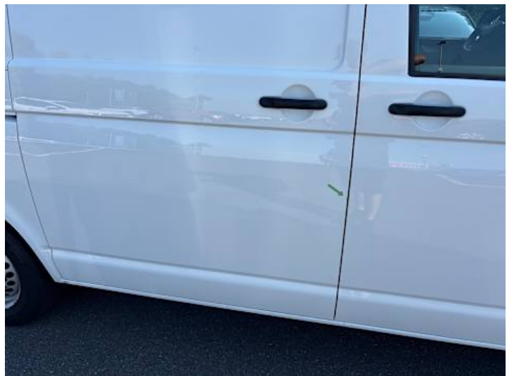
Türe hinten rechts (Lackschaden, Rost)
