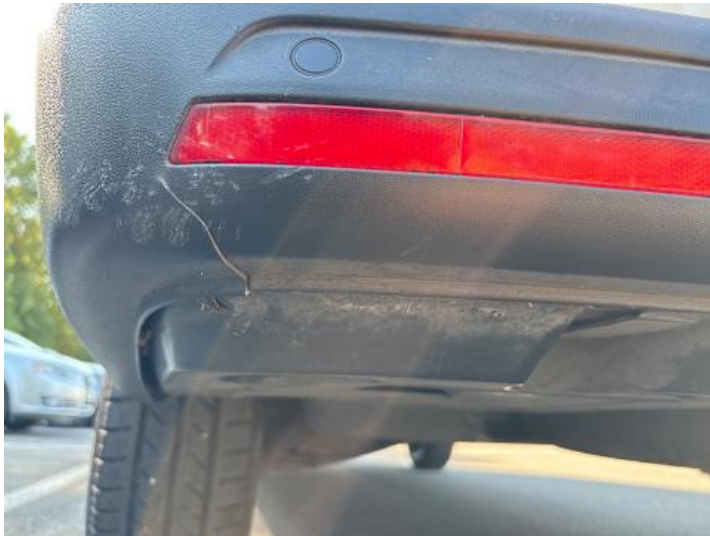
Stoßstange hinten (Kratzer, Riss/Bruch)
