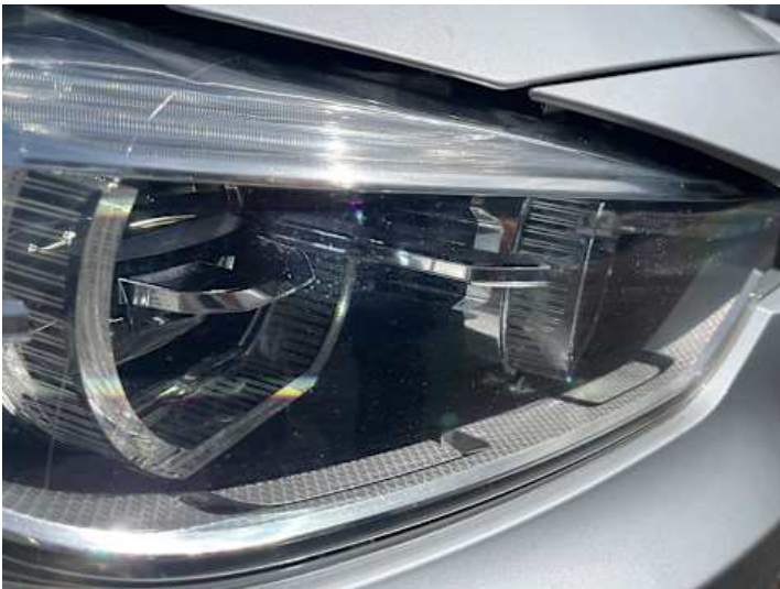
Scheinwerfer (rechts) (Kratzer, Steinschlag)
