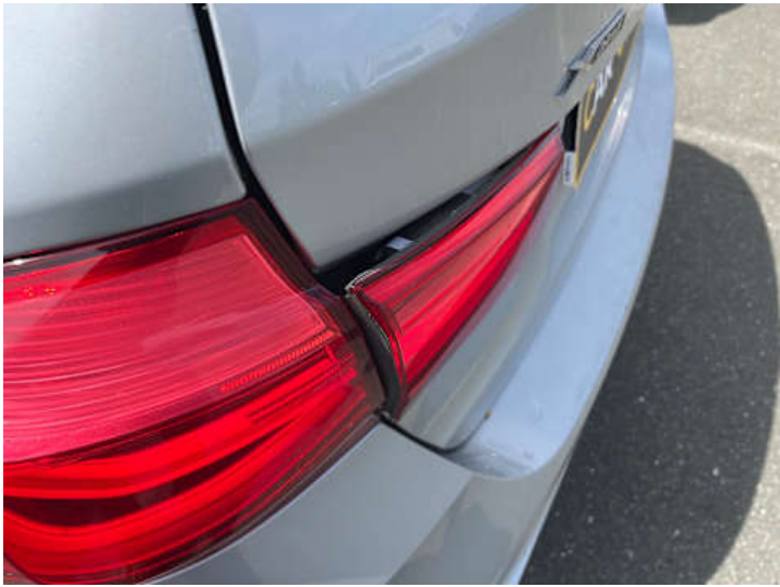
Rücklicht (rechts) (Anderer Schaden): Möglich Halter gebrochen
