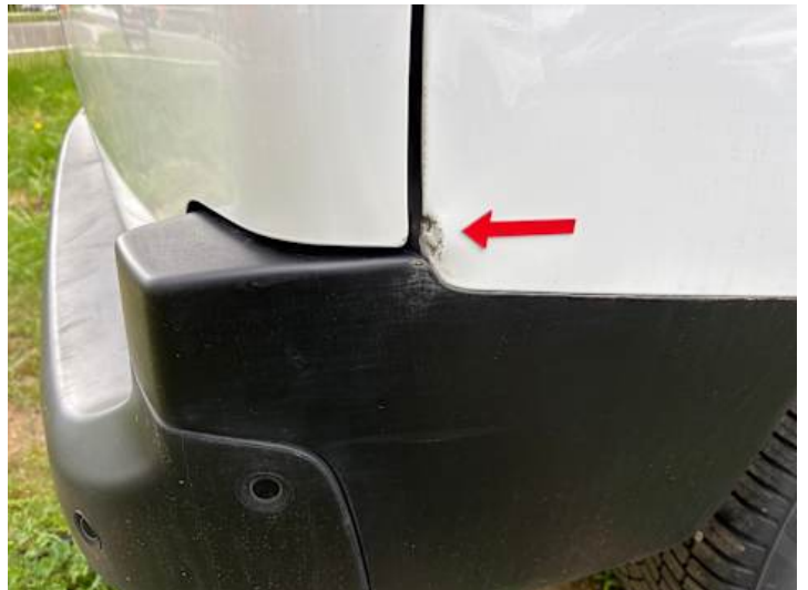
Seitenteil hinten rechts (Verformung, Kratzer)
