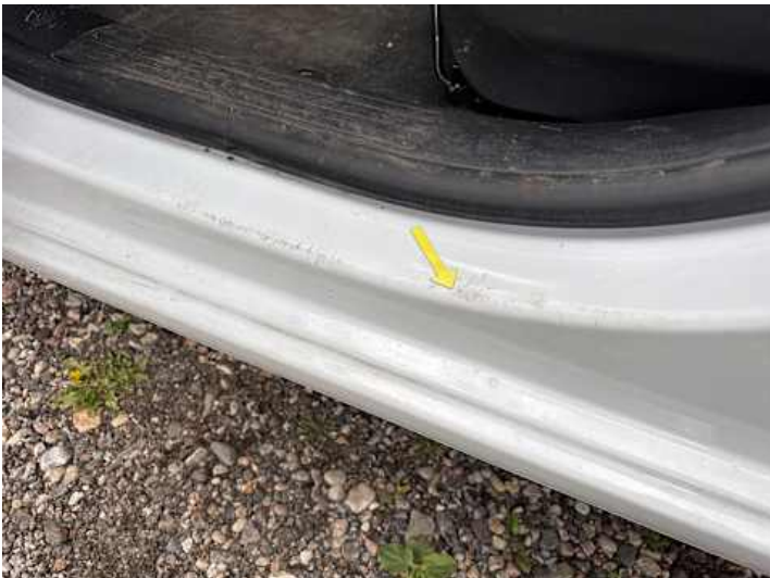
Schweller links (Kratzer)
