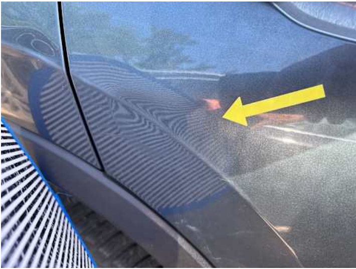
Türe hinten rechts (Delle, Lackschaden)
