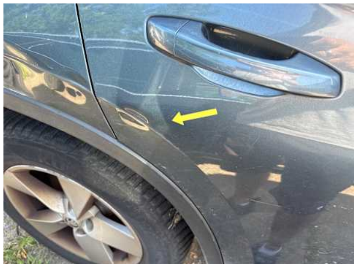
Türe hinten rechts (Delle, Lackschaden)
