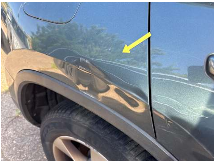
Seitenteil hinten rechts (Verformung)
