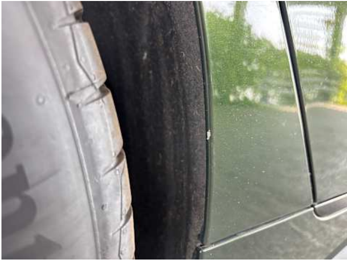
Seitenteil hinten rechts (Steinschlag)
