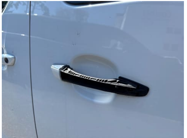
Türe hinten links (Riss/Bruch)
