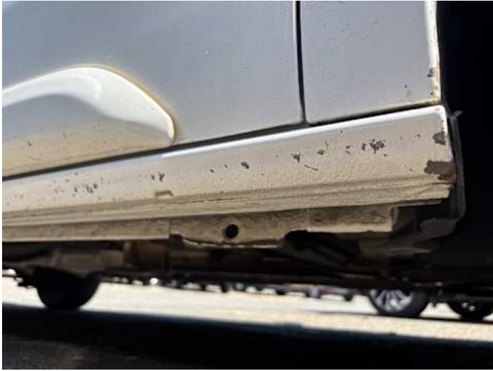
Schweller rechts (Lackschaden)
