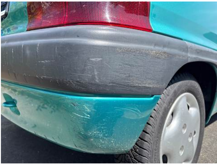
Stoßstange hinten (Kratzer, Verformung, Lackschaden)
