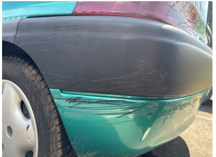
Stoßstange hinten (Kratzer, Verformung, Lackschaden)
