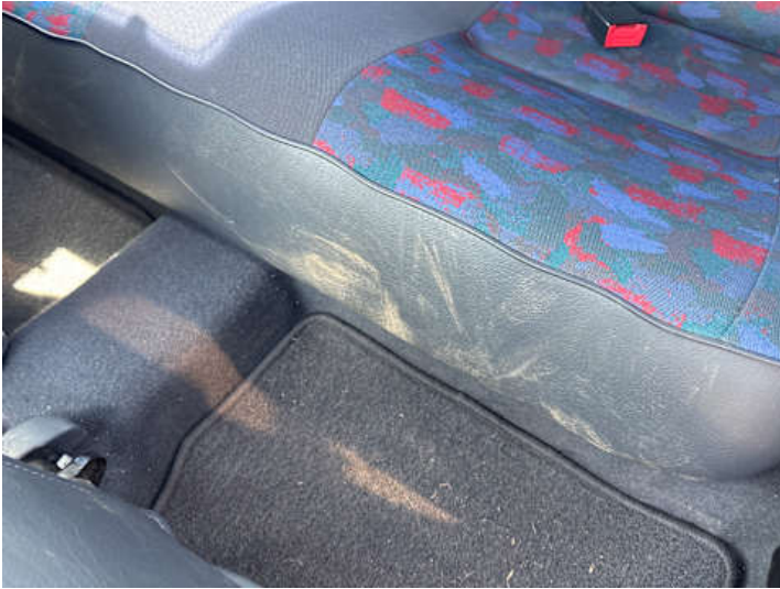
Innenraum (Kratzer, Verschleiß, Verschmutzung)
