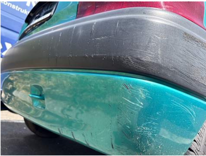
Stoßstange hinten (Kratzer, Verformung, Lackschaden)
