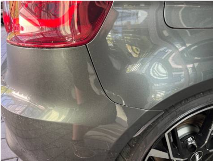
Stoßstange hinten (Spaltmaße ungenau)
