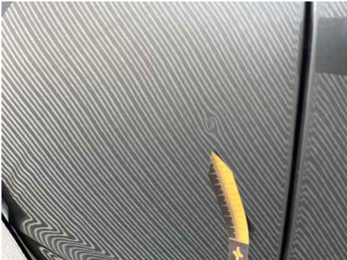
Türe hinten rechts (Delle, Lackschaden)
