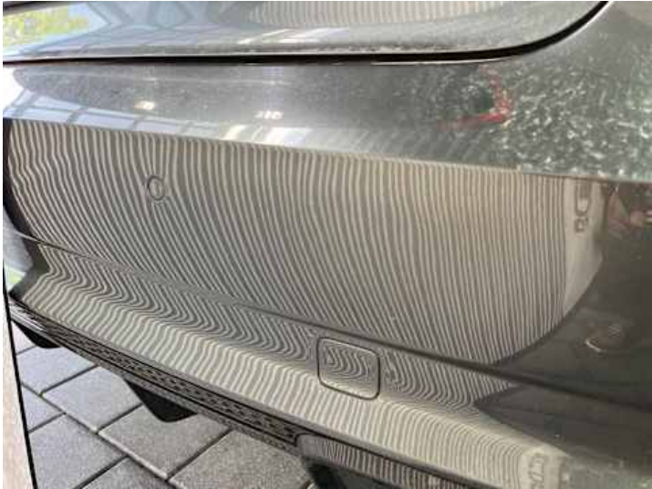
Stoßstange hinten (Verformung)
