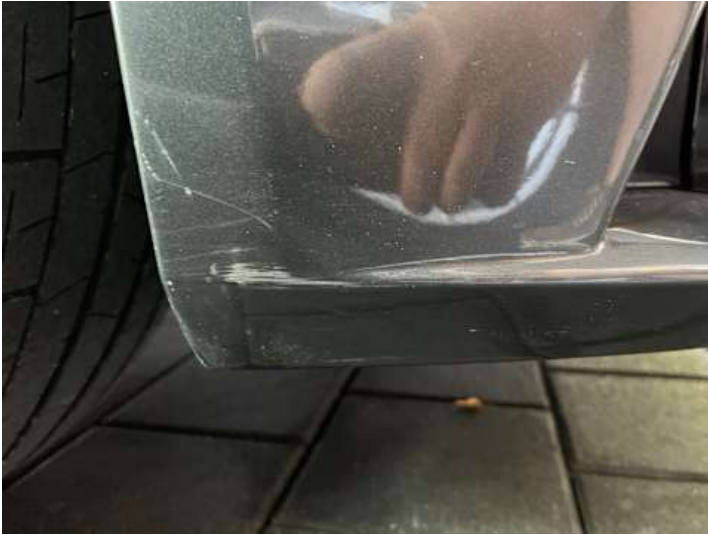
Stoßstange vorne (Kratzer, Lackschaden)
