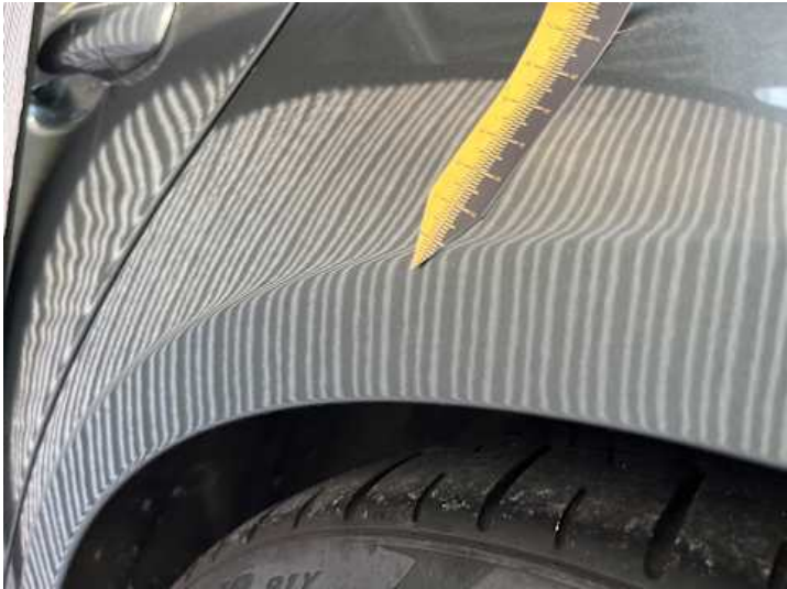
Seitenteil hinten links (Lackschaden, Unsachgemäß instand gesetzt)
