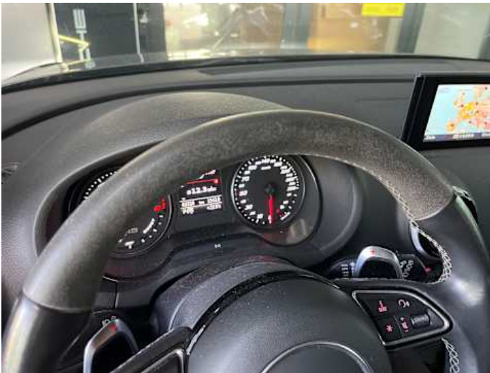
Innenraum (Diverse Schäden, Verschleiß)
