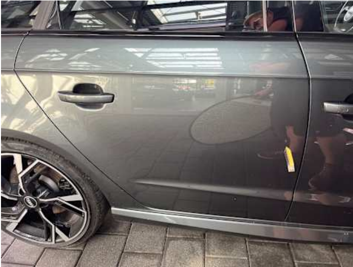
Türe hinten rechts (Delle, Lackschaden)
