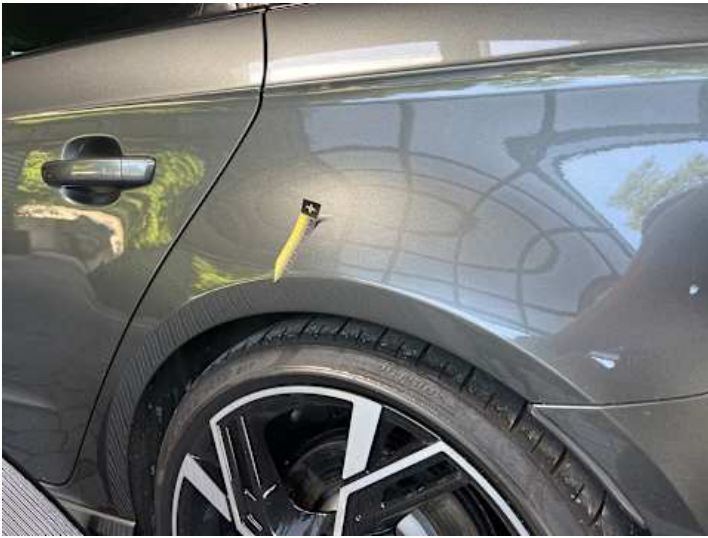
Seitenteil hinten links (Lackschaden, Unsachgemäß instand gesetzt)
