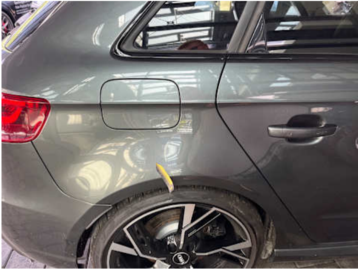
Seitenteil hinten rechts (Lackschaden, Unsachgemäß instand gesetzt)
