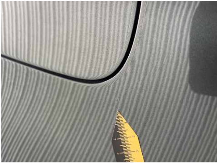
Seitenteil hinten rechts (Lackschaden, Unsachgemäß instand gesetzt)
