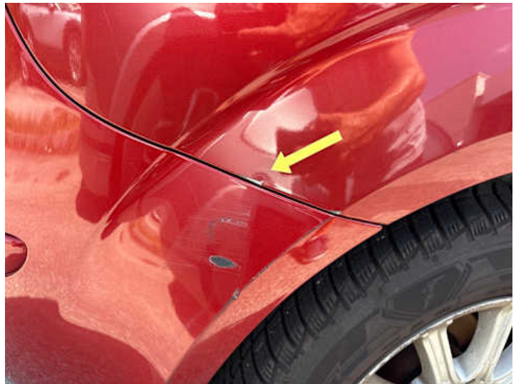
Seitenteil hinten rechts (Delle, Kratzer, Lackschaden)
