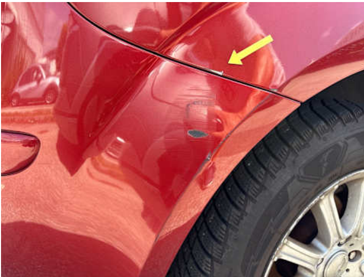
Stoßstange hinten (Kratzer, Lackschaden)
