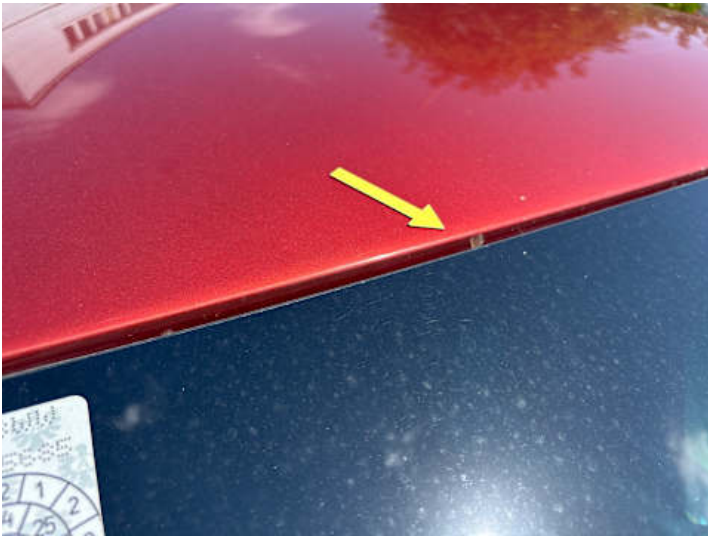
Dach (Steinschlag, Rost)
