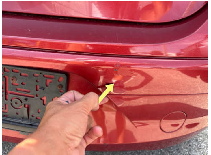
Stoßstange hinten (Kratzer, Lackschaden)
