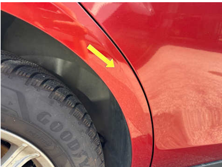
Seitenteil hinten rechts (Delle, Kratzer, Lackschaden)
