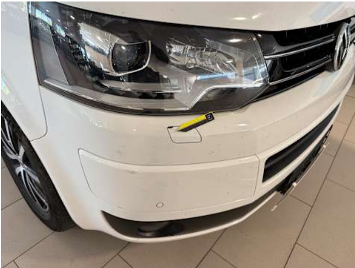
Stoßstange vorne (Riss/Bruch)
