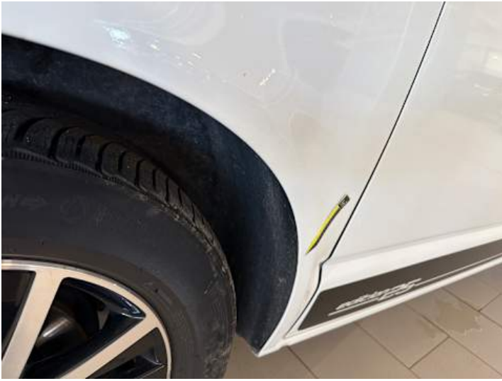
Seitenteil hinten rechts (Rost)
