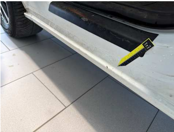
Schweller links (Kratzer, Rost)
