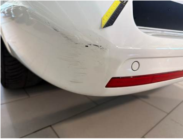
Stoßstange hinten (Kratzer)
