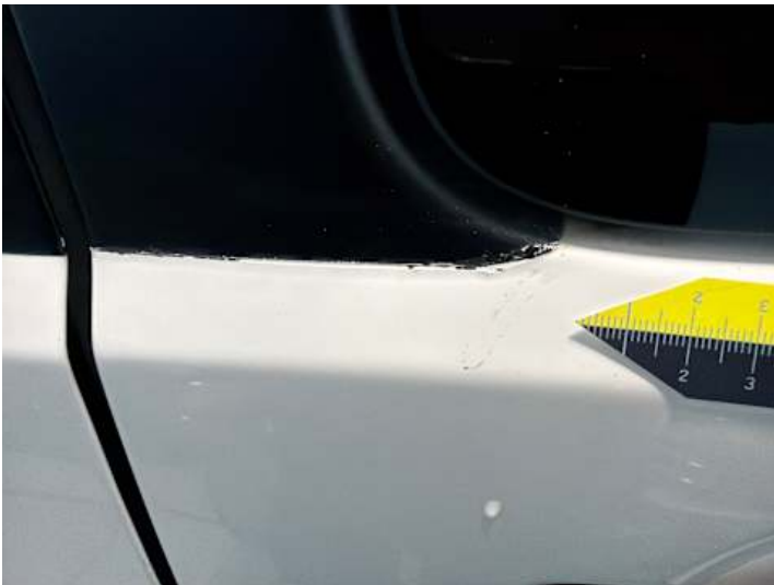
Türe hinten links (Unsachgemäß instand gesetzt)
