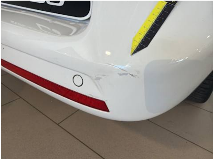
Stoßstange hinten (Kratzer)
