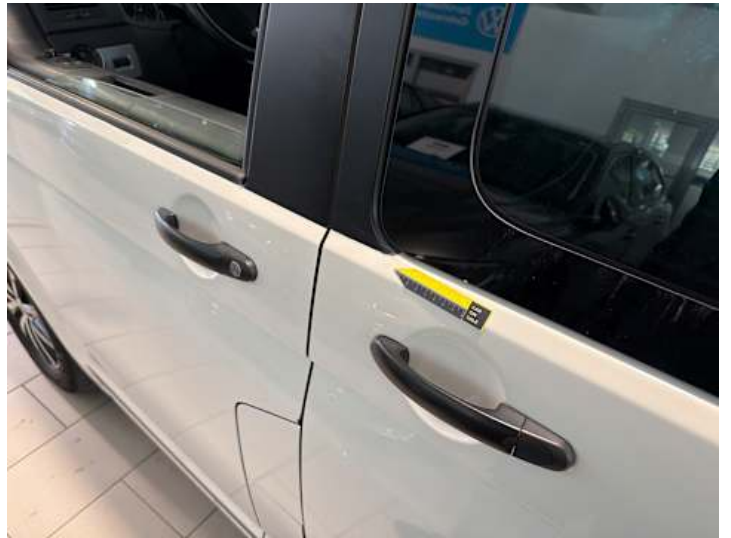
Türe hinten links (Unsachgemäß instand gesetzt)
