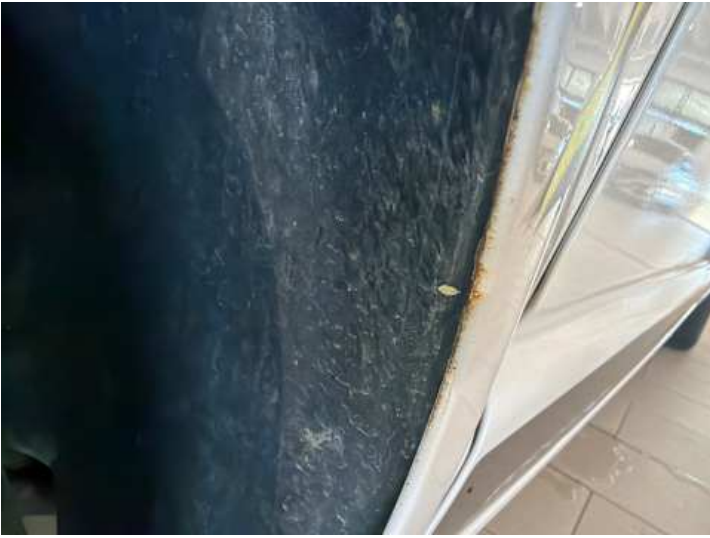
Seitenteil hinten rechts (Rost)
