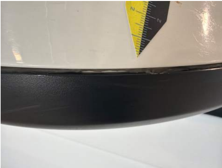
Beifahrertür (Unsachgemäß instand gesetzt, Kratzer)
