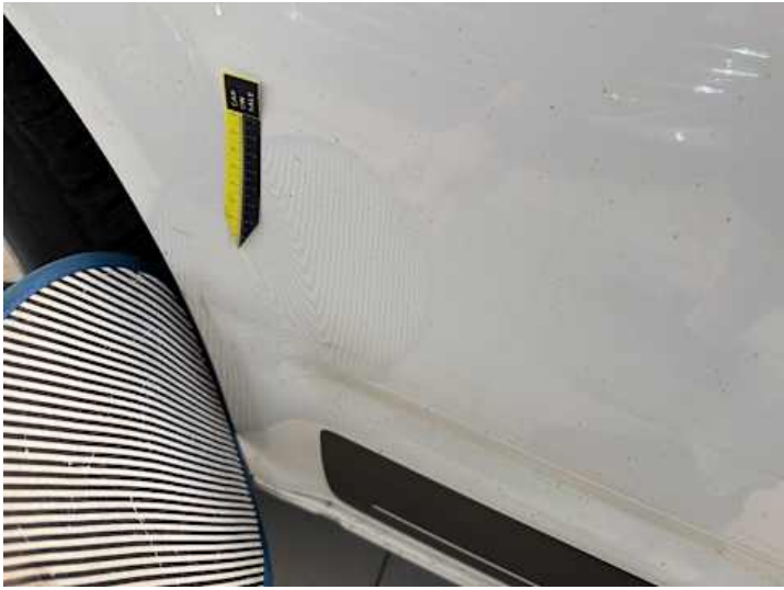
Fahrtür (Kratzer, Verformung)
