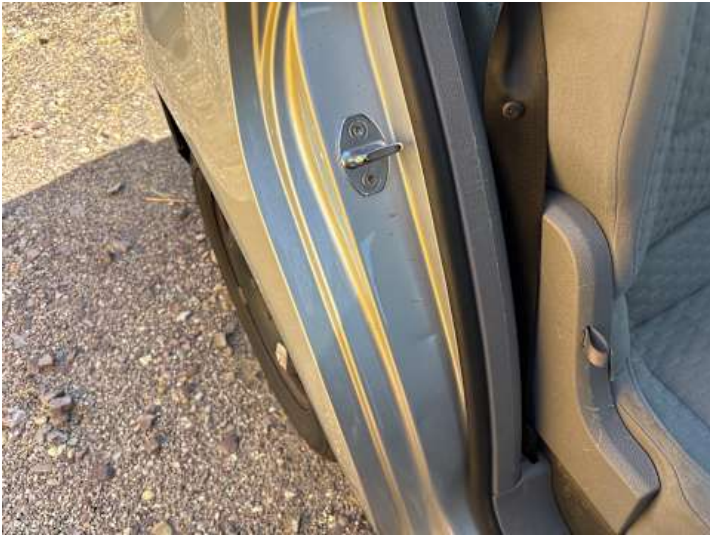
Seitenteil hinten rechts (Kratzer, Delle)
