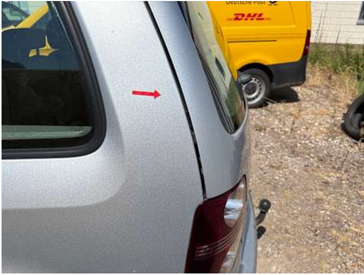
Heckklappe (Spaltmaße ungenau)
