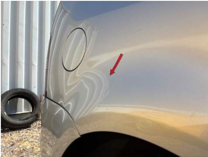
Seitenteil hinten rechts (Kratzer, Delle)
