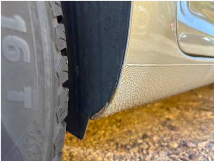
Schweller rechts (Rost)
