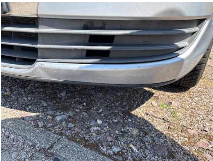
Stoßstange vorne (Unsachgemäß instand gesetzt)
