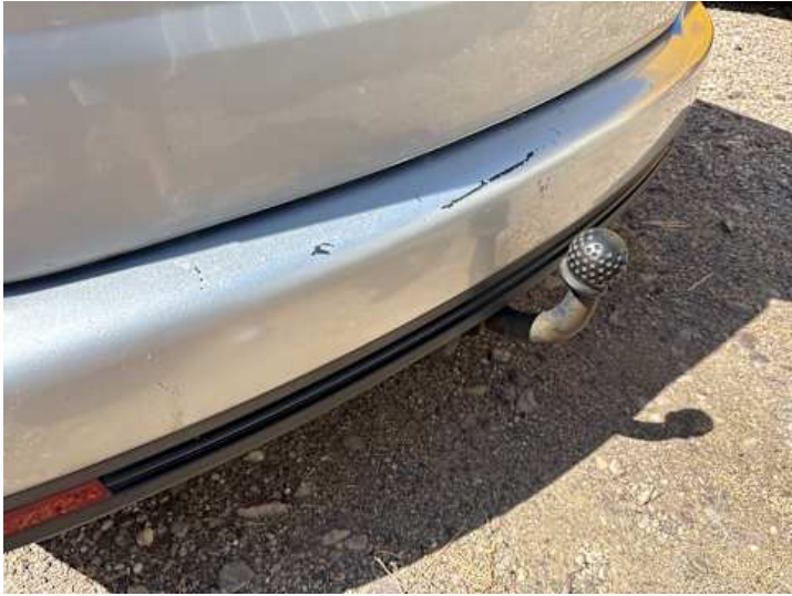
Stoßstange hinten (Kratzer, Delle, Verformung)
