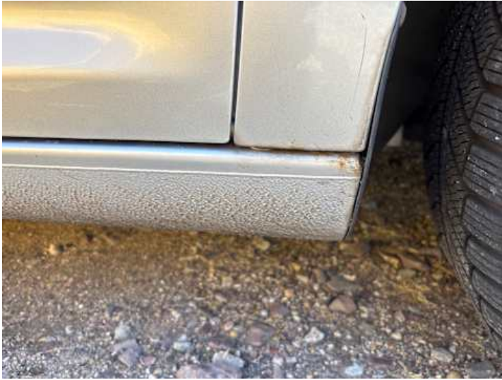
Schweller rechts (Rost)
