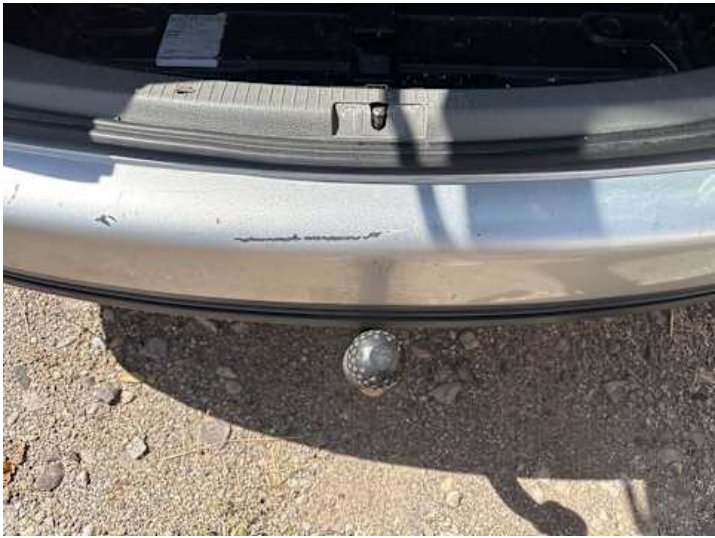
Stoßstange hinten (Kratzer, Delle, Verformung)
