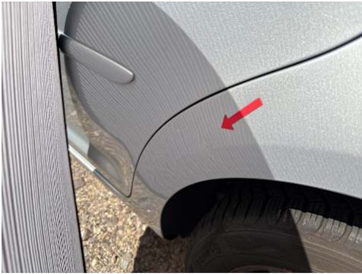
Seitenteil hinten links (Delle)
