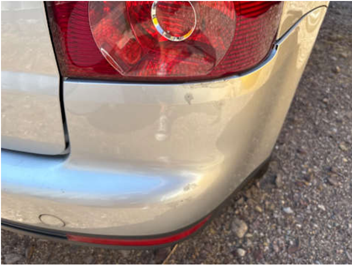
Stoßstange hinten (Kratzer, Delle, Verformung)
