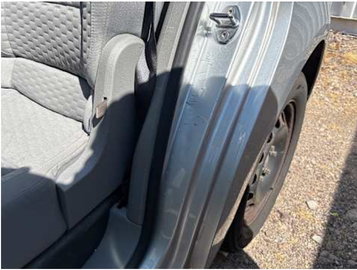
Seitenteil hinten links (Kratzer, Delle)
