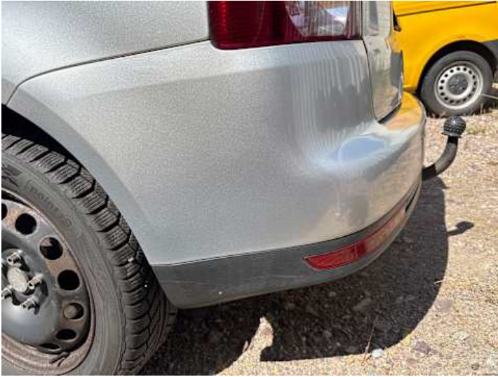
Stoßstange hinten (Kratzer, Delle, Verformung)
