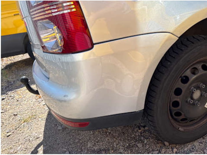
Stoßstange hinten (Kratzer, Delle, Verformung)
