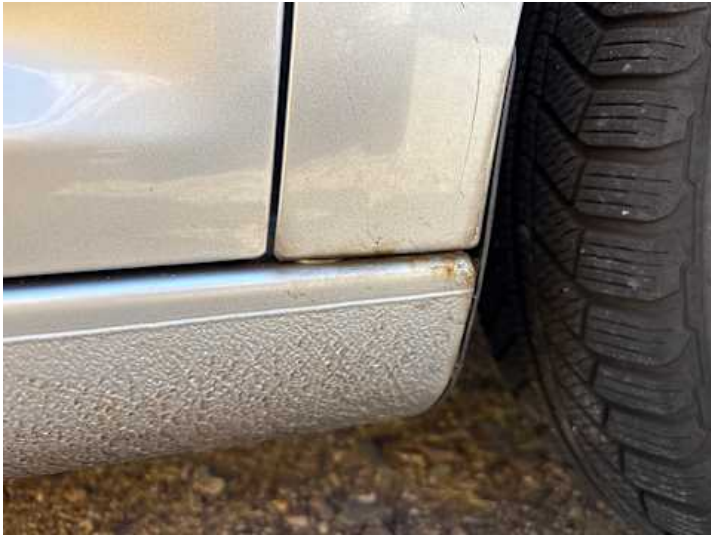
Kotflügel vorne rechts (Rost)
