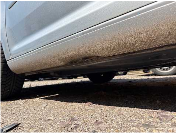
Schweller links (Verformung)
