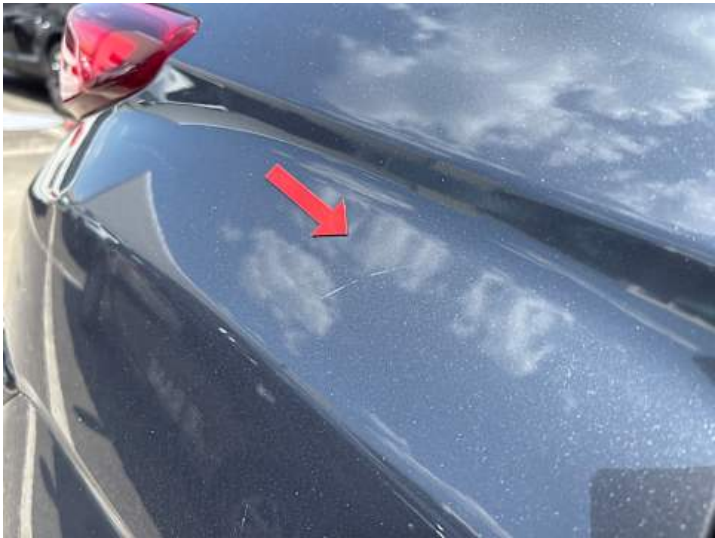
Seitenteil hinten rechts (Kratzer)
