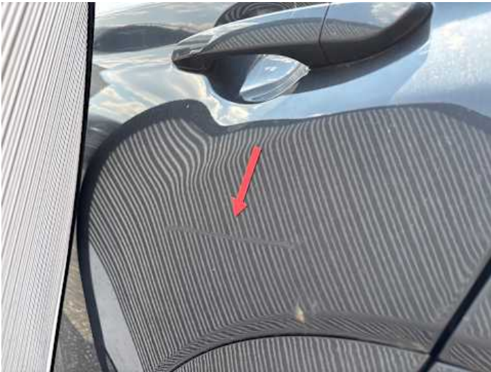
Seitenteil hinten links (Lackschaden, Unsachgemäß instand gesetzt)
