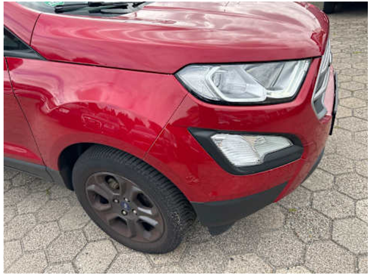
Stoßstange vorne (Anderer Schaden): Farbunterschied zwischen den einzelnen Bauteilen
