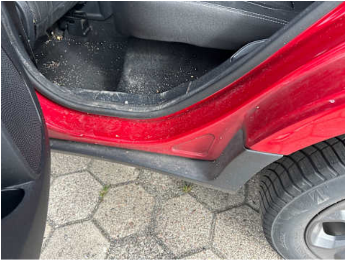
Schweller links (Kratzer)
