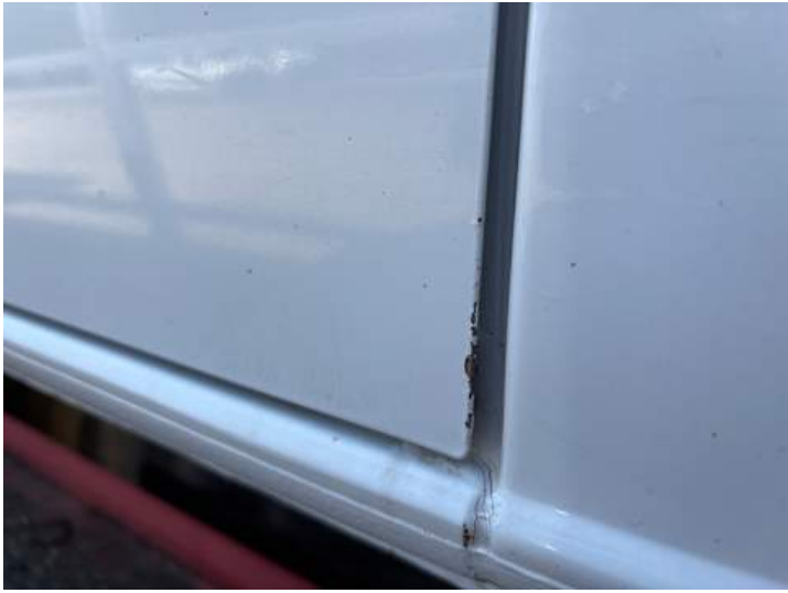
Türe hinten rechts (Lackschaden, Rost)
