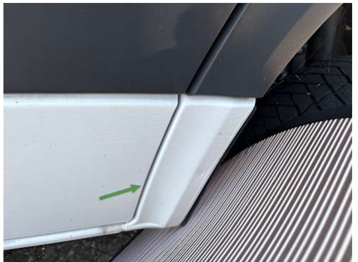
Schweller rechts (Delle)
