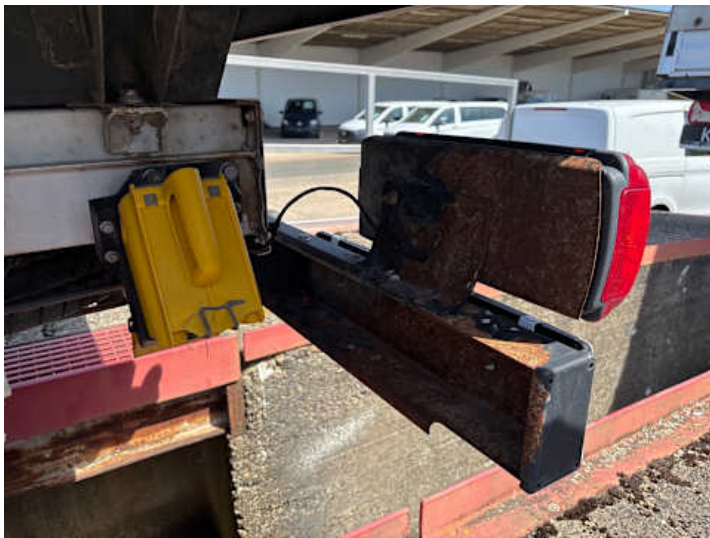
Stoßstange hinten (Rost, Lackschaden)
