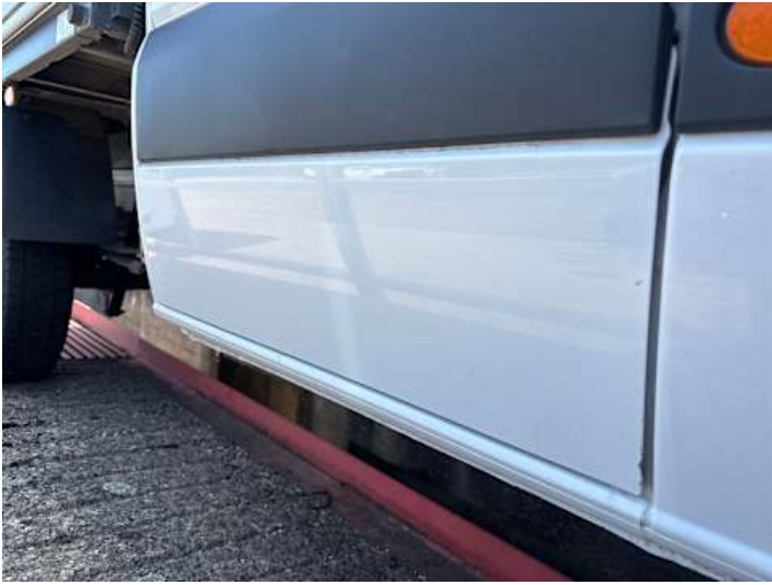
Türe hinten rechts (Lackschaden, Rost)
