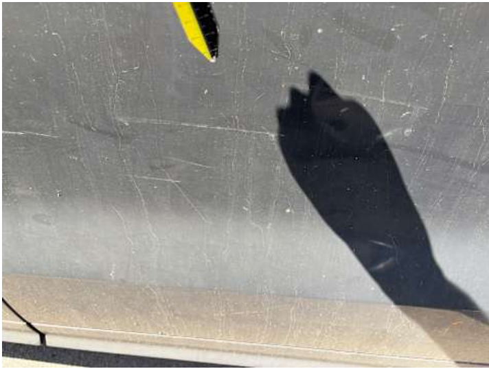
Türe hinten links (Lackschaden, Kratzer)
