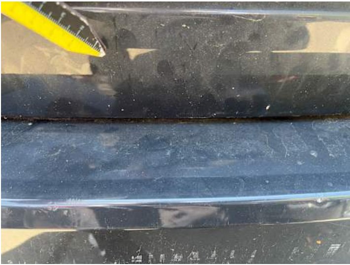
Heckklappe (Lackschaden, Kratzer)
