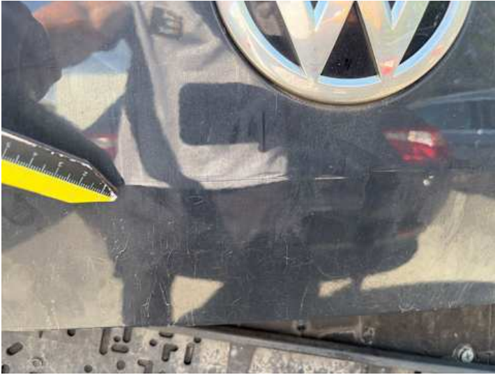
Heckklappe (Lackschaden, Kratzer)
