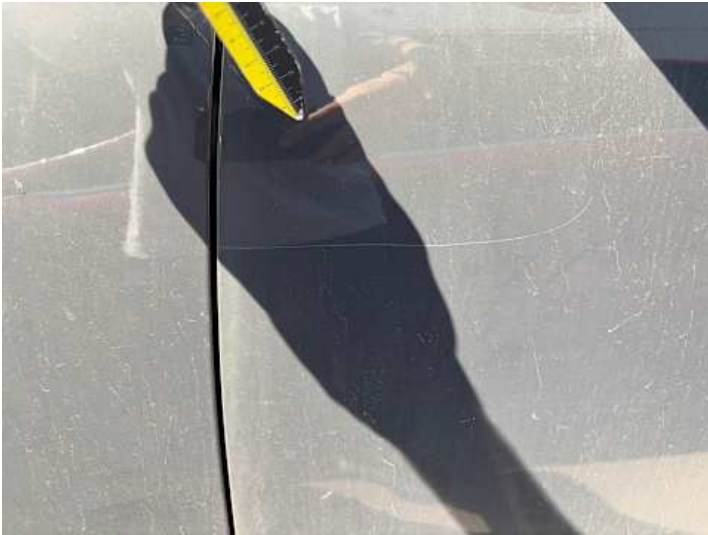
Fahrtür (Lackschaden, Kratzer)
