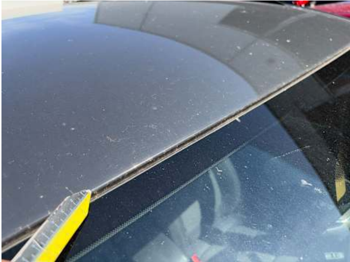
Dach (Lackschaden, Steinschlag)
