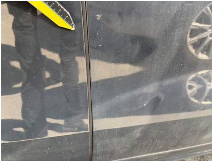
Beifahrtür (Lackschaden, Kratzer)
