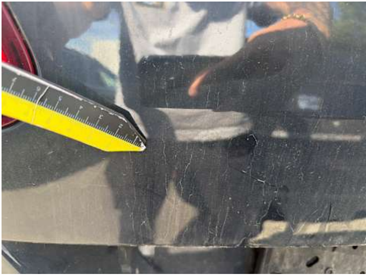
Heckklappe (Lackschaden, Kratzer)
