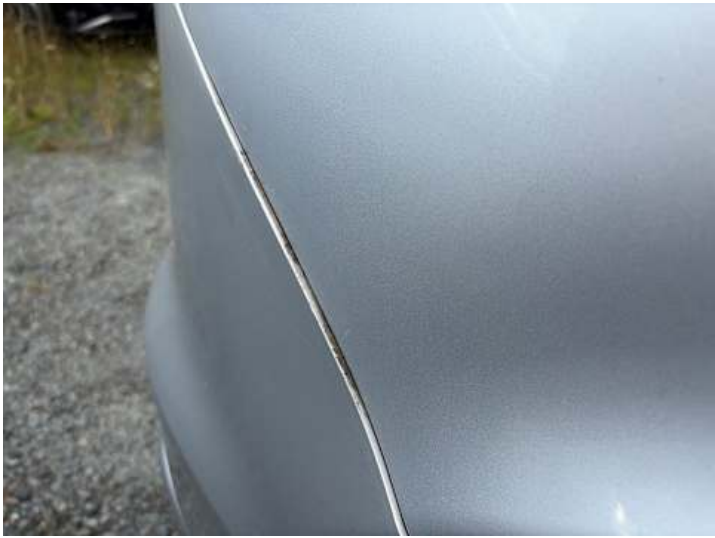
Seitenteil hinten rechts (Spaltmaße ungenau)
