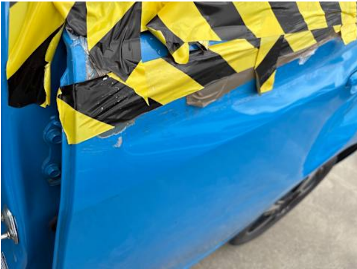
Seitenteil hinten links (Verformung, Kratzer, Spaltmaße ungenau)
