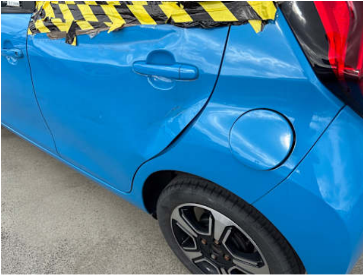
Türe hinten links (Verformung, Kratzer)
