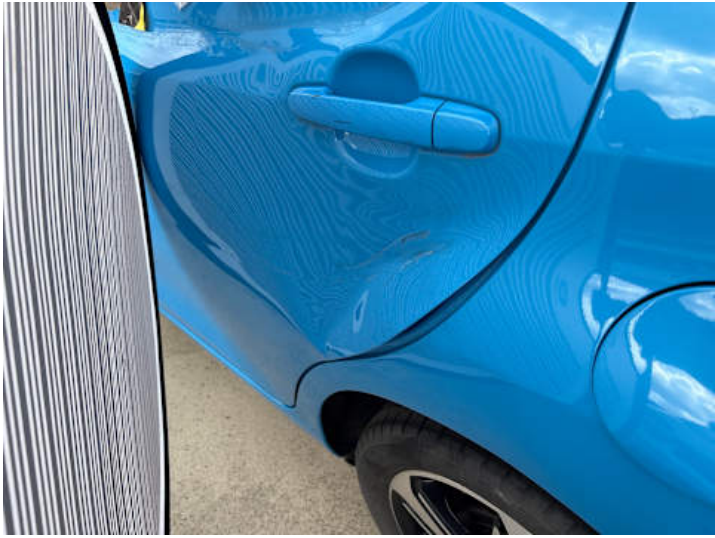
Türe hinten links (Verformung, Kratzer)
