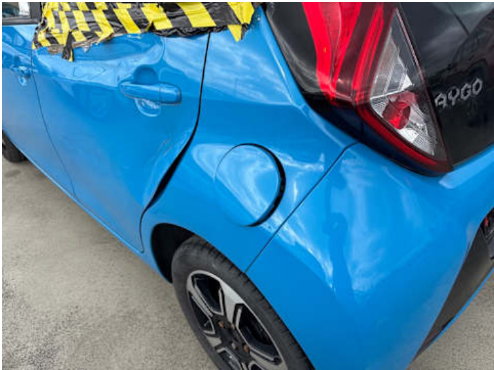
Seitenteil hinten links (Verformung, Kratzer, Spaltmaße ungenau)
