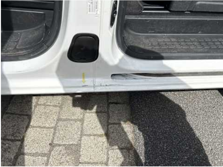
Schweller links (Lackschaden)
