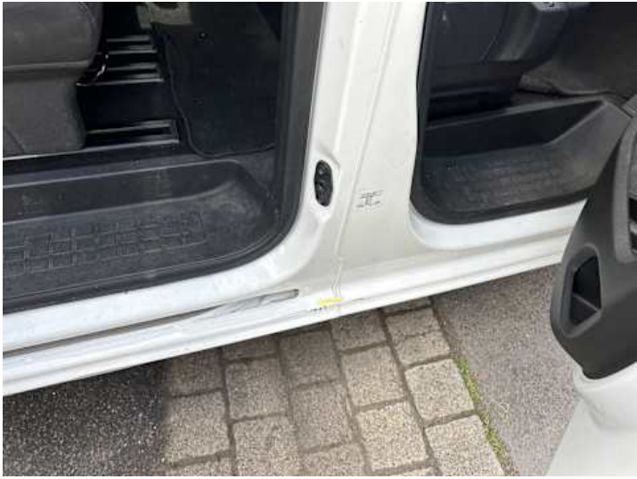
Schweller rechts (Lackschaden)
