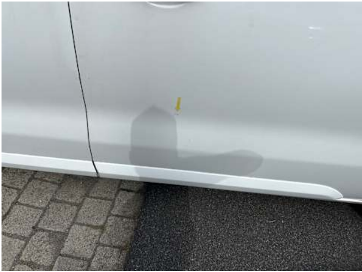
Türe hinten links (Lackschaden)
