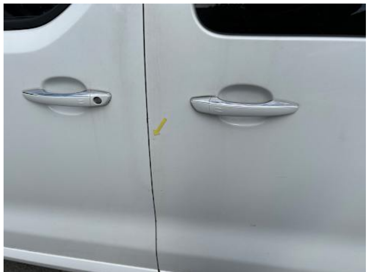
Türe hinten links (Delle, Lackschaden)
