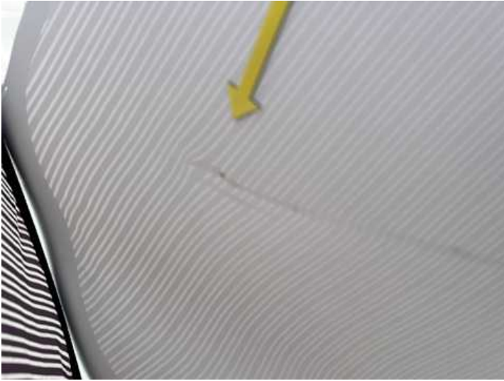
Türe hinten rechts (Lackschaden, Verformung)
