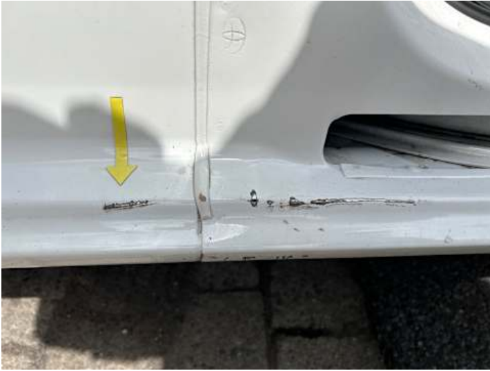
Schweller links (Lackschaden)
