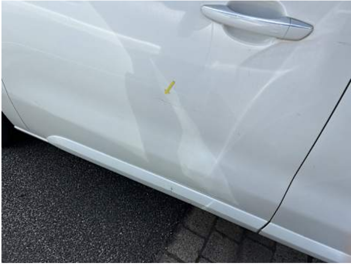
Türe hinten rechts (Lackschaden, Verformung)
