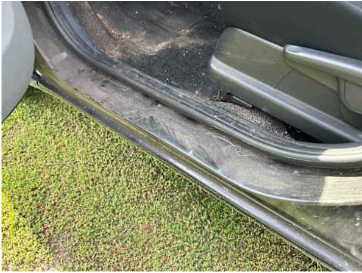
Schweller links (Kratzer)
