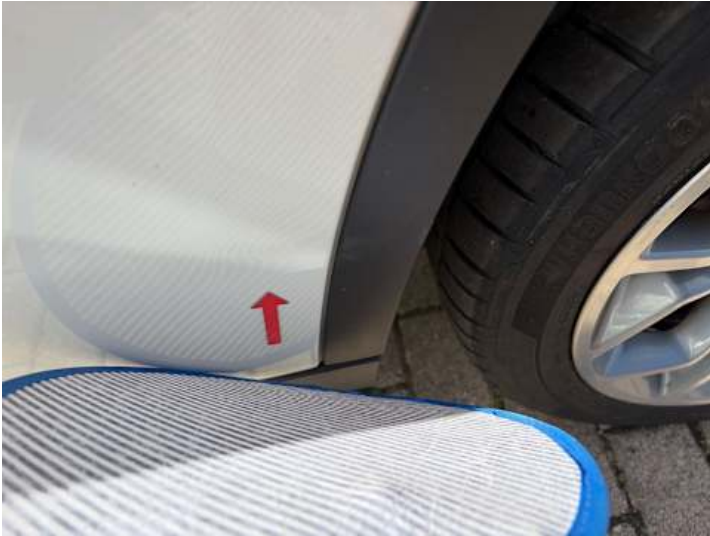
Kotflügel vorne rechts (Delle, Verformung)
