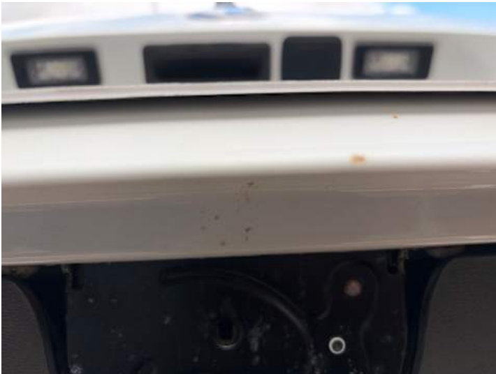
Heckklappe (Rost, Lackschaden)
