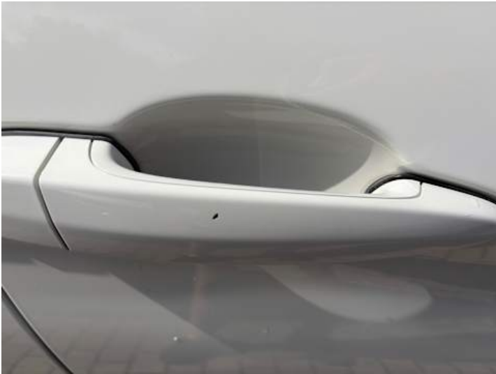
Beifahrertür (Lackschaden, Steinschlag)
