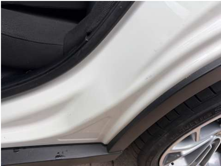
Seitenteil hinten rechts (Kratzer, Delle)
