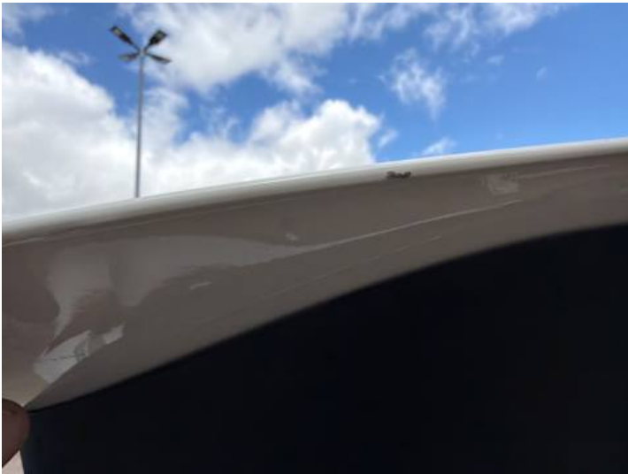
Heckklappe (Rost, Lackschaden)
