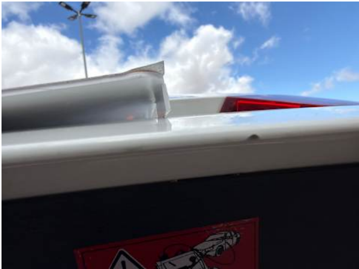
Heckklappe (Rost, Lackschaden)
