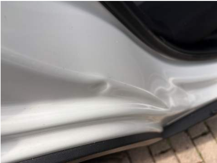
Seitenteil hinten rechts (Delle)
