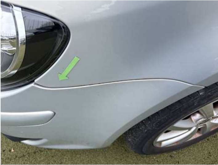
Stoßstange vorne (Spaltmaße ungenau)
