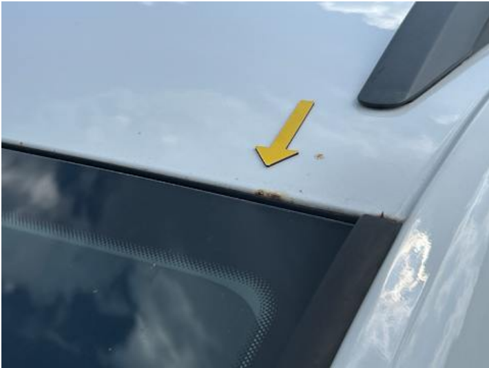
Dach (Rost, Steinschlag)
