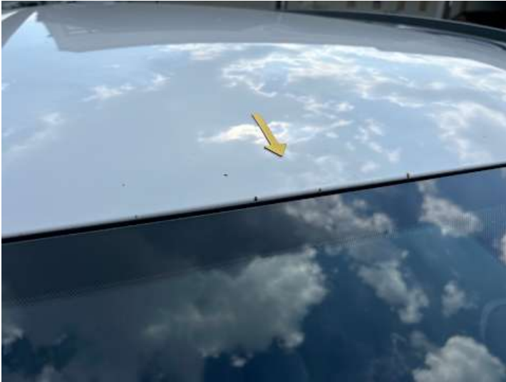
Dach (Rost, Steinschlag)
