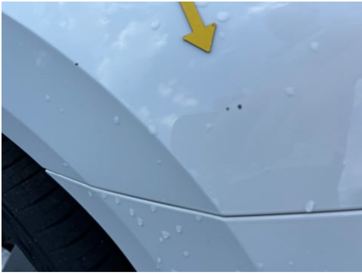
Kotflügel vorne rechts (Steinschlag)
