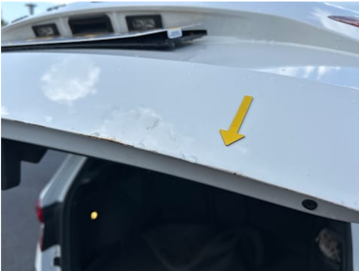
Heckklappe (Kratzer, Rost)
