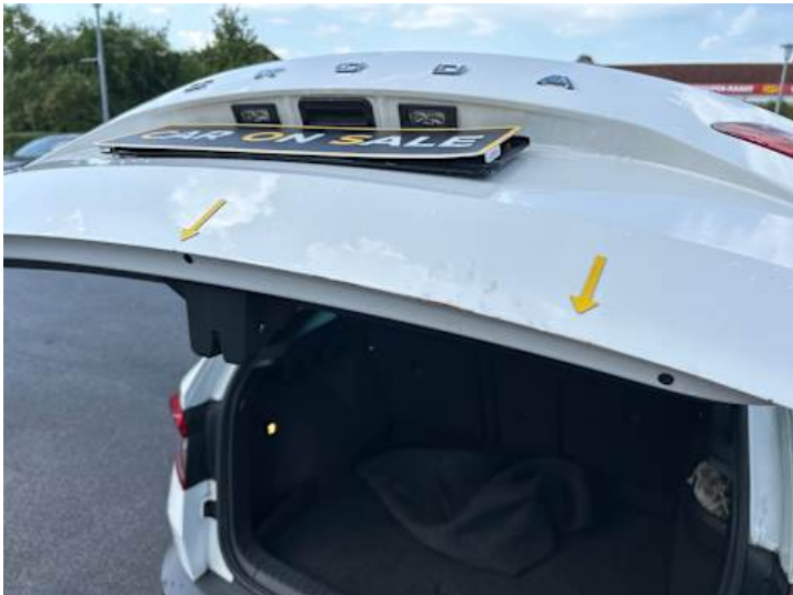
Heckklappe (Kratzer, Rost)
