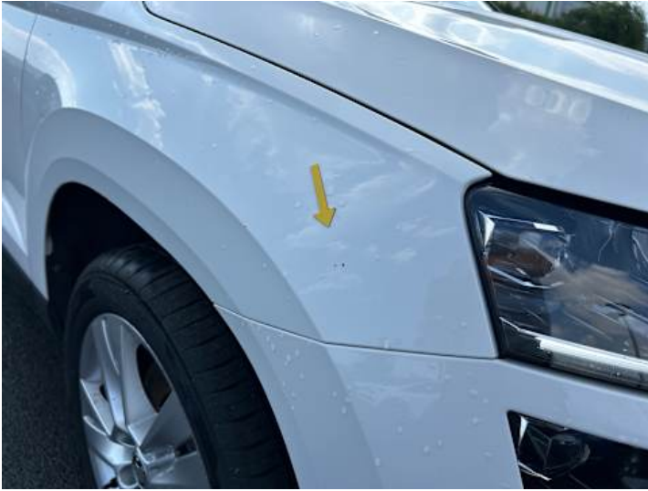
Kotflügel vorne rechts (Steinschlag)
