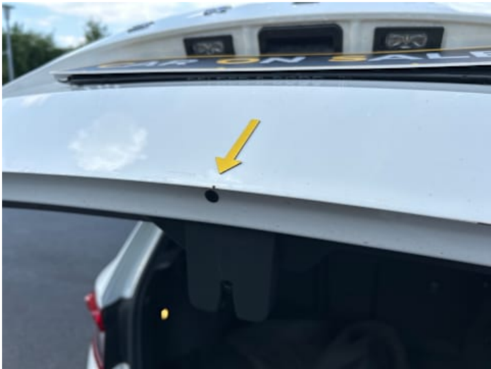
Heckklappe (Kratzer, Rost)
