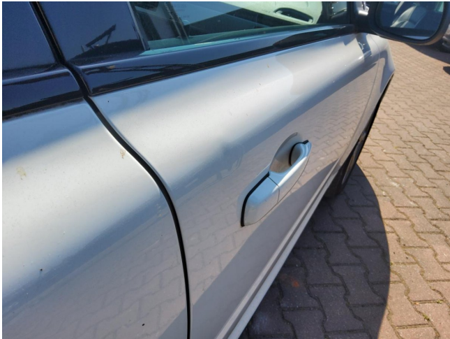
Tür vorne rechts - Delle entfernen
