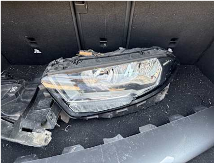
Scheinwerfer (links) (Riss/Bruch)
