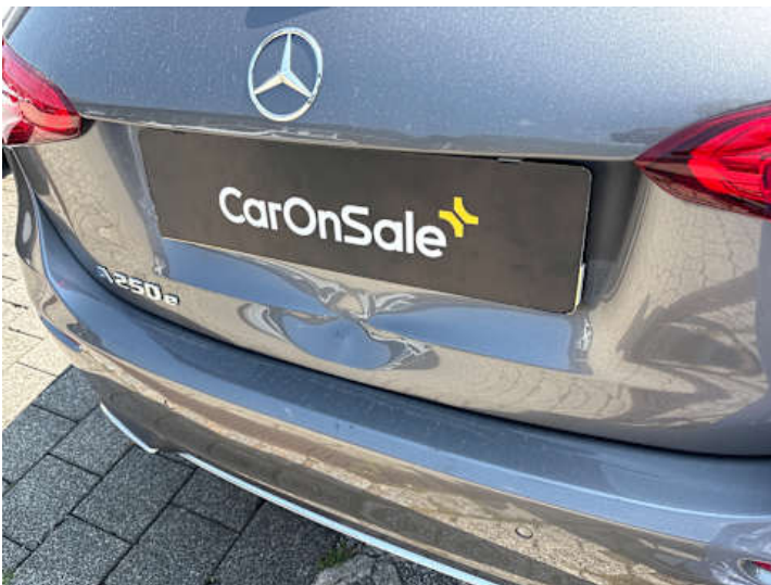
Heckklappe (Delle, Verformung, Kratzer, Lackschaden)
