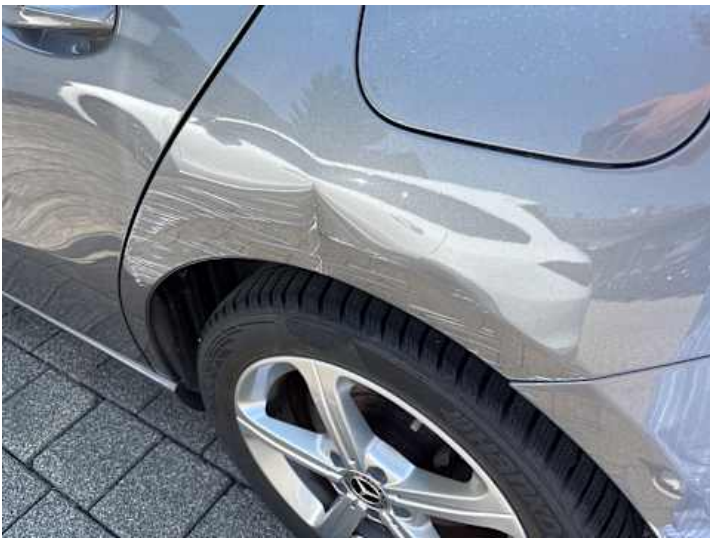
Seitenteil hinten links (Kratzer, Lackschaden, Verformung, Delle)
