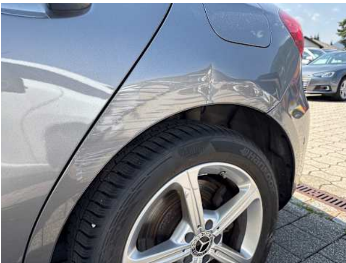
Seitenteil hinten links (Kratzer, Lackschaden, Verformung, Delle)
