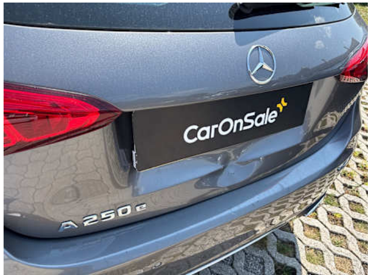
Heckklappe (Delle, Verformung, Kratzer, Lackschaden)
