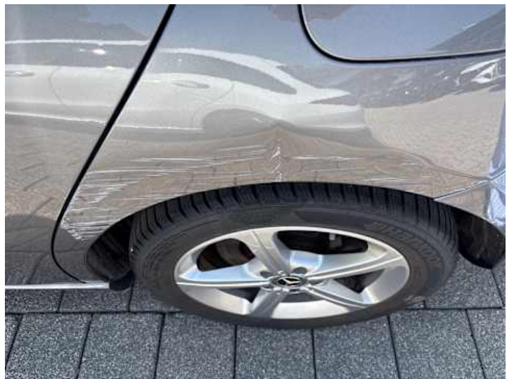
Seitenteil hinten links (Kratzer, Lackschaden, Verformung, Delle)
