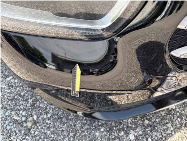
Stoßstange vorne (Kratzer, Lackschaden, Unsachgemäß instand gesetzt, Ausgeblichen/Matt)
