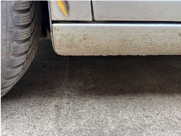
Schweller links (Rost)
