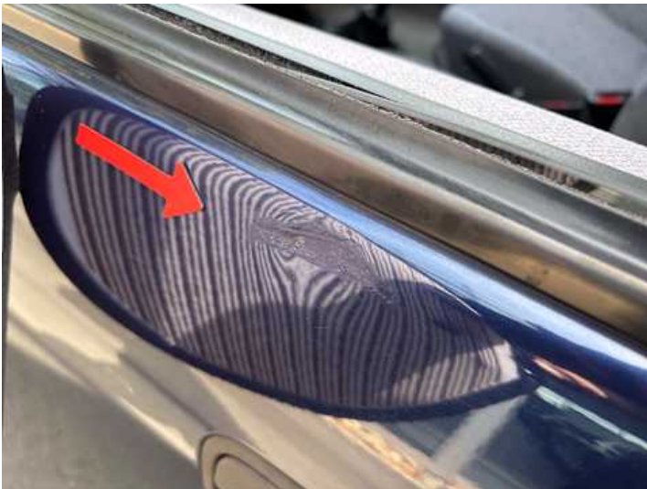
Fahrtür (Kratzer, Rost, Unsachgemäß instand gesetzt, Delle)
