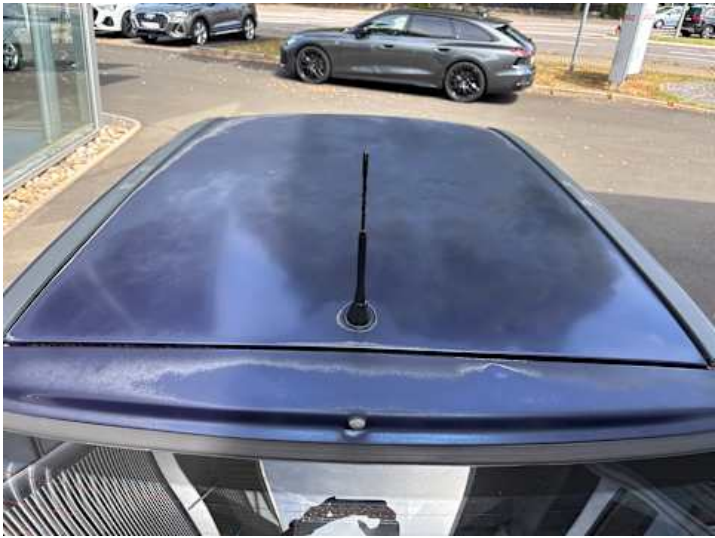
Dach (Ausgeblichen/Matt, Lackschaden)
