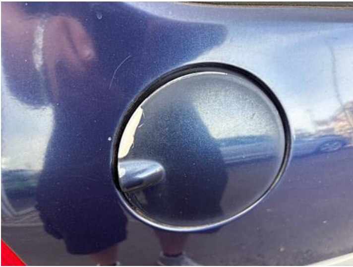
Seitenteil hinten rechts (Lackschaden)
