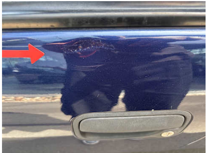
Fahrtür (Kratzer, Rost, Unsachgemäß instand gesetzt, Delle)
