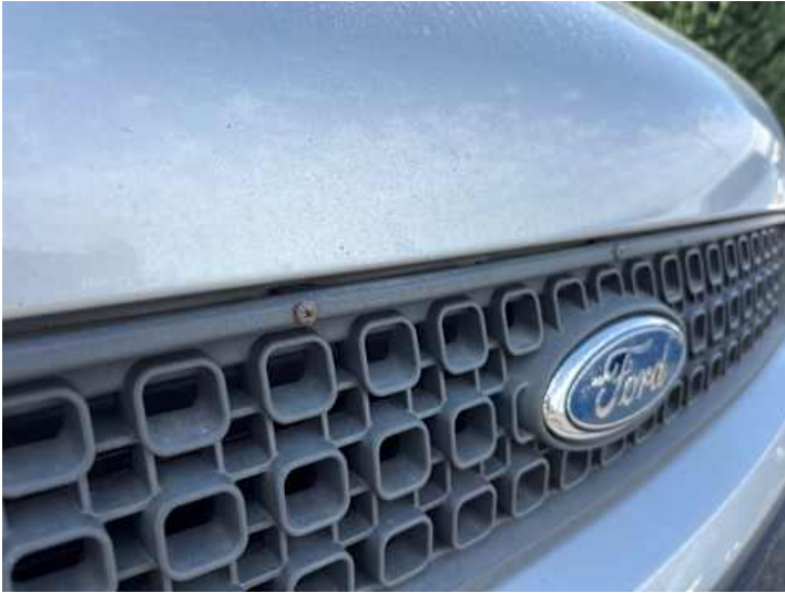
Motorhaube (Unsachgemäß instand gesetzt)
