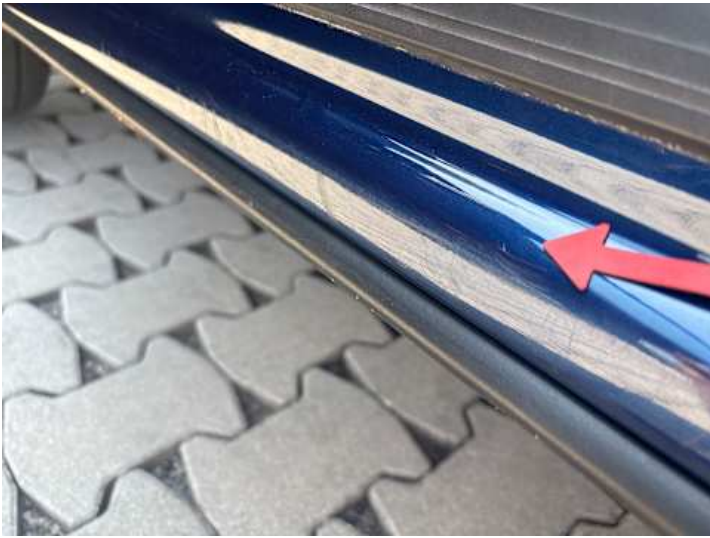
Schweller links (Kratzer, Rost)
