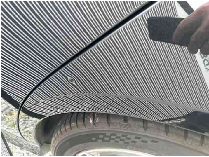
Seitenteil hinten links (Delle)
