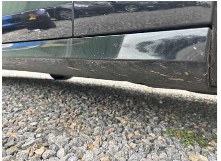
Schweller rechts (Verformung, Kratzer)
