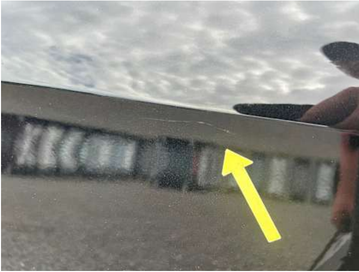
Seitenteil hinten links (Kratzer)
