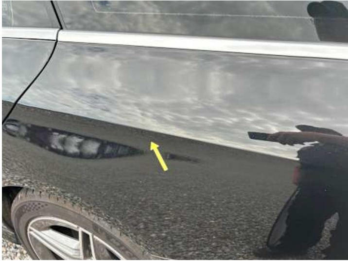
Seitenteil hinten links (Kratzer)
