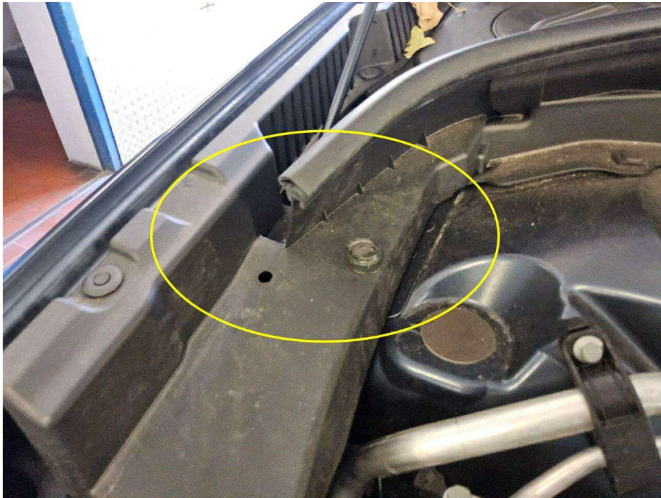
Bild 7 : Motorraumabdichtung links, mittig und rechts Tierverschiss
