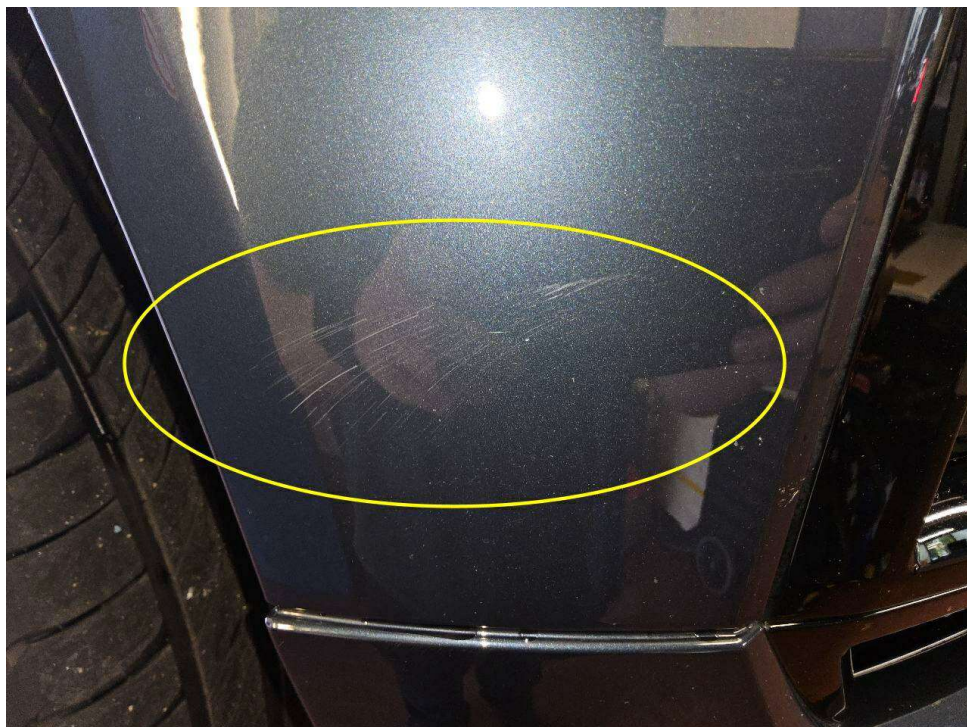
Bild 12 : Stoßfänger vorne rechts verkratzt
