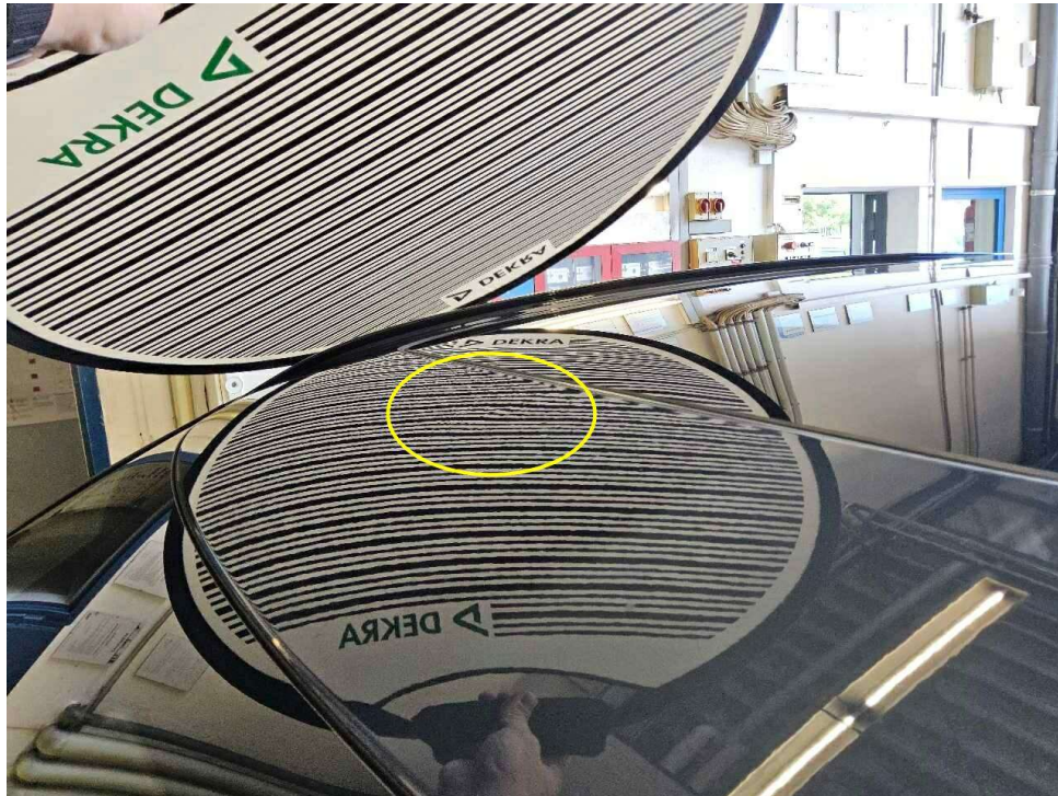
Bild 11 : Dach vorne mittig eingedellt
