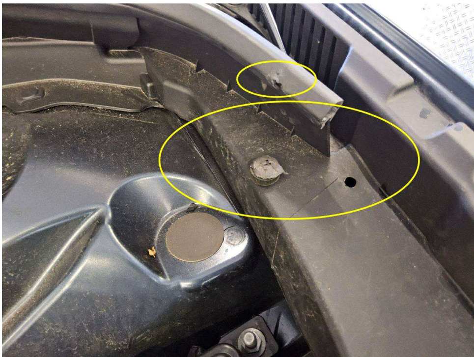
Bild 8 : Motorraumabdichtung links, mittig und rechts Tierverschiss
